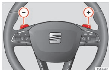
Fig. 145 Volante: palancas para cambio automático.
