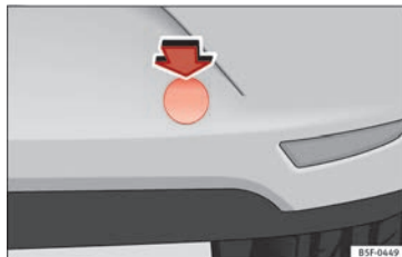
Fig. 192 Parte derecha del parachoques trasero: tapa-cubierta.
