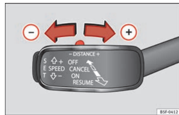
Fig. 155 Palanca de mando: ajustar la distancia.
