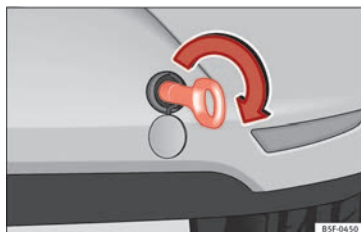
Fig. 193 Parte derecha del parachoques trasero: argolla de remolque enroscada.
