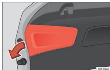
Fig. 220 Retirar la cubierta del portón del maletero.
