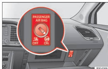
Fig. 74 Conmutador del airbag frontal del acompañante.
