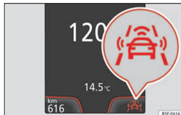
Fig. 160 En la pantalla del cuadro de instrumentos: indicación de Front Assist desactivado.
