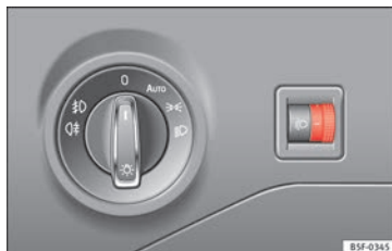
Fig. 100 Al lado del volante: regulador del alcance de las luces.
