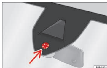
Fig. 104 Superficie sensible del sensor de lluvia.
