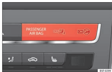
Fig. 73 Testigo de control en el tablero de instrumentos para la desactivación del airbag frontal del acompañante.
