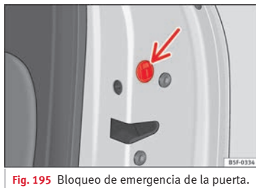
Fig. 195 Bloqueo de emergencia de la puerta.
