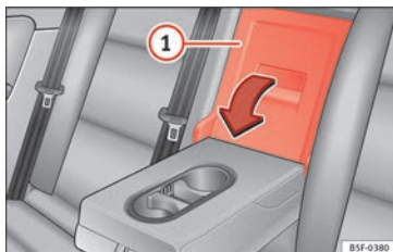
Fig. 128 En el respaldo del asiento trasero: apertura de la trampilla.
