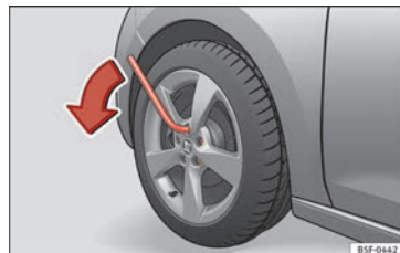
Fig. 185 Rueda: aflojar los tornillos de rueda.
