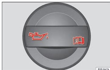
Fig. 176 Tapón de la boca de llenado de aceite del motor en el vano motor.
