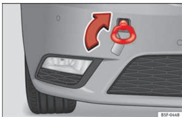
Fig. 191 Parte derecha del parachoques delantero: argolla de remolque enroscada.
