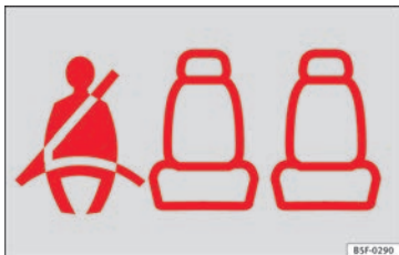
Fig. 60 Cuadro de instrumentos: indicación de plaza posterior derecha ocupada y abrochado el cinturón correspondiente.
