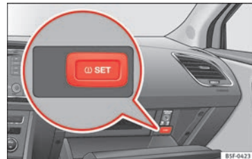
Fig. 180 Guantera: interruptor para el control de los neumáticos.
