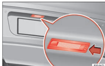
Fig. 223 En el parachoques posterior: luz de matrícula.
