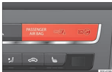
Fig. 75 Testigo para desconexión de airbag del acompañante.
