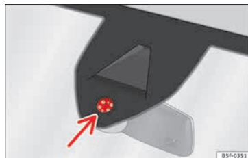
Fig. 144 Superficie sensible del sensor de lluvia.
