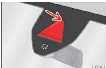
Fig. 208 En el parabrisas: área de campo visual del sistema de aviso de salida del carril.
