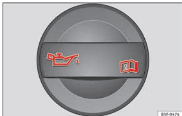
Fig. 236 Tapón de la boca de llenado de aceite del motor en el vano motor.
