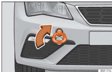
Fig. 101 Parte derecha del parachoques delantero: argolla de remolque enroscada.
