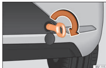
Fig. 103 Parte derecha del parachoques trasero: argolla de remolque enroscada.
