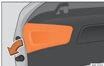
Fig. 119 Retirar la cubierta del portón trasero
