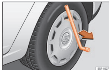
Fig. 74 Retirar el embellecedor integral.
