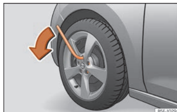
Fig. 77 Rueda: aflojar los tornillos de rueda.
