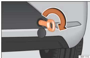
Fig. 81 Parte derecha del parachoques trasero: argolla de remolque enroscada.
