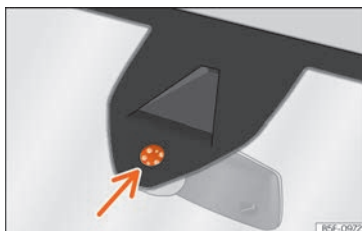
Fig. 157 Superficie sensible del sensor de lluvia.
