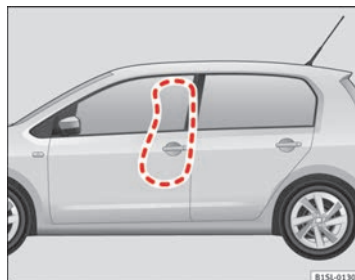
Fig. 51 En el lado izquierdo del vehículo: zona de despliegue del airbag lateral.
