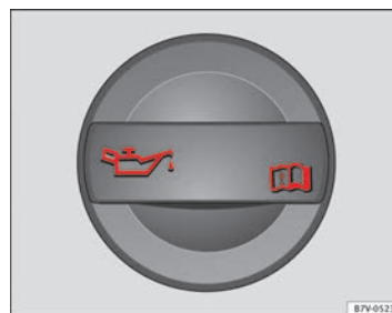
Fig. 112 En el vano motor: Tapón de la boca de llenado del aceite del motor.
