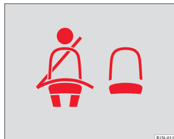
Fig. 36 Indicación del estado del cinturón para las plazas traseras en la pantalla del cuadro de instrumentos.
