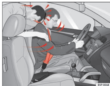
Fig. 40 El ocupante del asiento trasero que no lleve puesto el cinturón de seguridad se verá lanzado hacia adelante, sobre el conductor que sí lleva el cinturón.
