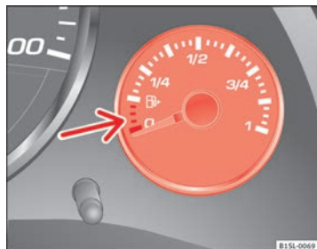
Fig. 105 En el cuadro de instrumentos: indicador del nivel de combustible para gasolina.
