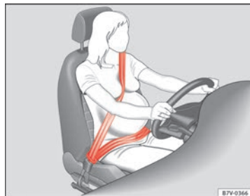
Fig. 45 Correcta colocación de la banda del cinturón en el caso de mujeres embarazadas.
