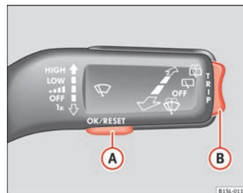
Fig. 11 Palanca del limpiaparabrisas: tecla (A) para confirmar puntos de la indicación y tecla basculante (B) para cambiar los puntos de la indicación.
