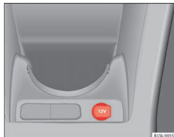
Fig. 82 Consola central delantera: toma de corriente de 12 voltios en el portaobjetos.
