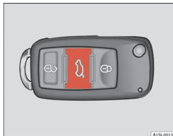
Fig. 22 En la llave del vehículo: Botón para desbloquear y abrir el portón trasero.
