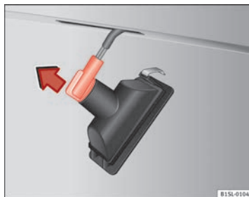
Fig. 156 Luz de la matrícula: Desmontar el portalámparas.
