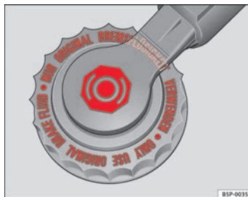
Fig. 91 En el vano motor: tapón del depósito del líquido de frenos
