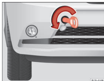
Fig. 162 En la parte derecha del parachoques delantero: Enroscar la argolla de remolque.
