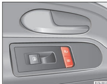
Fig. 19 En la puerta del conductor: botón del cierre centralizado.
