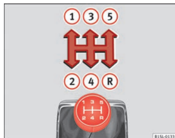
Fig. 86 Esquema de un cambio manual de 5 marchas.
