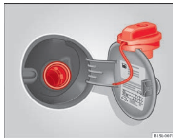
Fig. 107 Tapa del depósito abierta con el tapón enganchado en ella.
