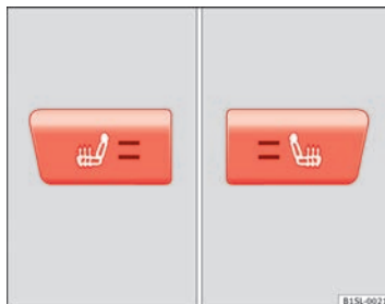
Fig. 34 En la consola central: Mandos para la calefacción de los asientos delanteros.
