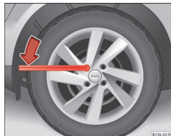
Fig. 141 Cambio de rueda: afloje los tornillos de la rueda.
