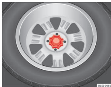
Fig. 123 En el maletero: rueda de mano para la fijación de la rueda de repuesto.
