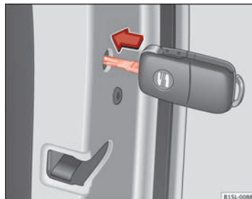
Fig. 134 Bloqueo de emergencia del vehículo con la llave del vehículo.
