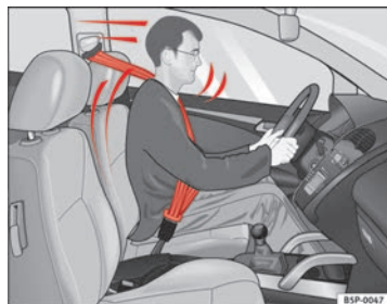
Fig. 41 Los conductores que lleven el cinturón de seguridad correctamente abrochado no saldrán despedidos en caso de frenazos repentinos.
