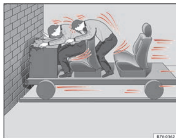
Fig. 38 Un vehículo colisiona contra un muro con los ocupantes sin abrochar el cinturón.
