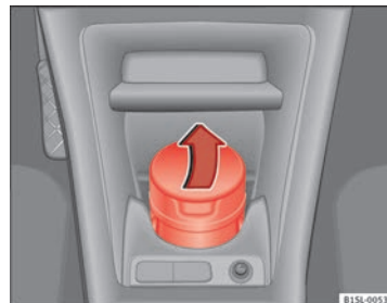
Fig. 80 En la parte delantera de la consola central: Abrir el cenicero.
