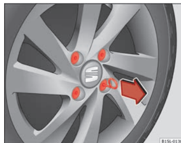
Fig. 140 Quitar los capuchones de los tornillos de la rueda.
