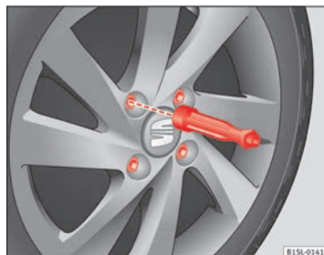
Fig. 145 Cambio de rueda: aflojar los tornillos de la rueda con el mango del destornillador.
