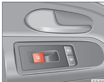
Fig. 24 En la puerta del conductor: tecla para el elevalunas.
