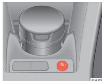
Fig. 81 En la parte delantera de la consola central: encendedor.
