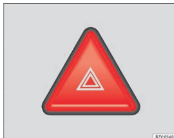
Fig. 130 Tablero de instrumentos: Tecla para encender y apagar los intermitentes de emergencia.
