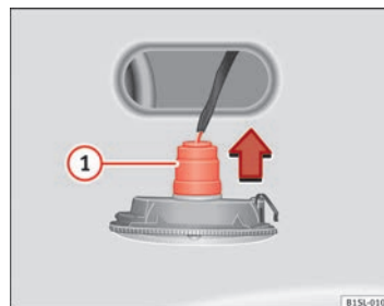
Fig. 158 Intermitente lateral: Cambio de las lámparas.
