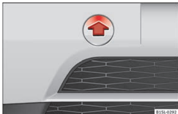
Fig. 135 En la parte derecha del parachoques delantero: quitar la cubierta.
