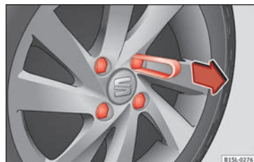
Fig. 126 Quitar los capuchones de los tornillos de la rueda.
