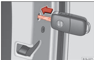
Fig. 139 Bloqueo de emergencia del vehículo con la llave del vehículo.
