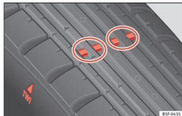
Fig. 116 Perfil del neumático: indicadores de desgaste.
