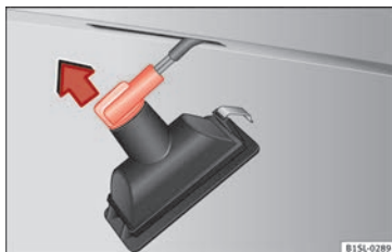
Fig. 152 Luz de la matrícula: desmontar el portalámparas.
