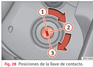
Fig. 28 Posiciones de la llave de contacto.
