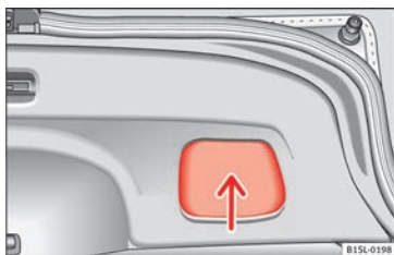
Fig. 107 Portón trasero abierto: cavidad para tirar.
