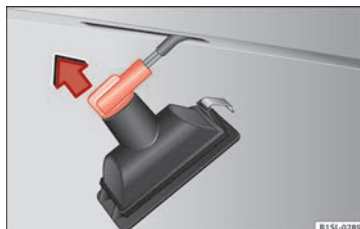
Fig. 91 Luz de la matrícula: desmontar el portalámparas.
