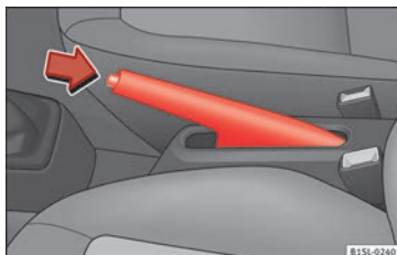
Fig. 146 Entre los asientos delanteros: freno de mano.
