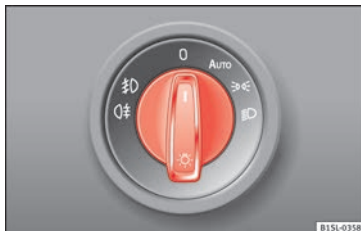
Fig. 109 Al lado del volante: representación de algunas variantes del mando de las luces.
