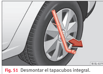
Fig. 51 Desmontar el tapacubos integral.
