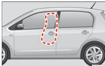
Fig. 22 En el lado izquierdo del vehículo: zona de despliegue del airbag lateral.
