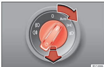
Fig. 29 Tablero de instrumentos: mando de las luces.
