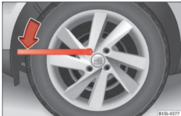
Fig. 53 Cambio de rueda: afloje los tornillos de la rueda.
