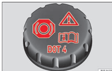
Fig. 43 Vano motor: tapón del depósito del líquido de frenos.
