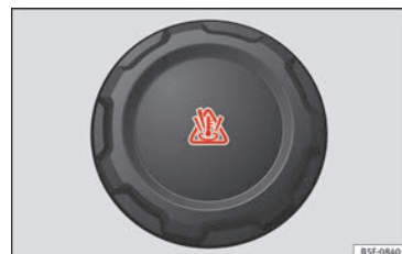
Fig. 42 Vano motor: tapón del depósito de expansión del líquido refrigerante.
