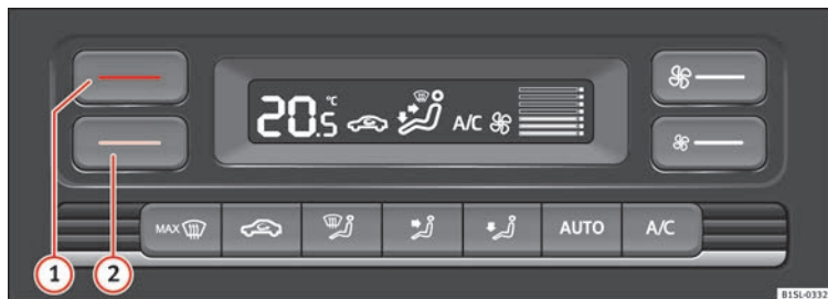
Fig. 144 En la parte superior de la consola central: mandos del Climatronic.
