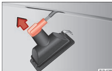
Fig. 91 Luz de la matrícula: desmontar el portalámparas.
