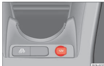
Fig. 133 Consola central delantera: toma de corriente de 12 voltios en el portaobjetos.
