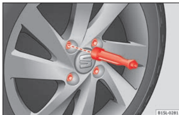
Fig. 57 Cambio de rueda: aflojar los tornillos de la rueda con el mango del destornillador.
