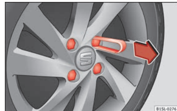
Fig. 52 Quitar los capuchones de los tornillos de la rueda.
