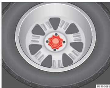
Fig. 177 En el maletero: rueda de mano para la fijación de la rueda de repuesto.
