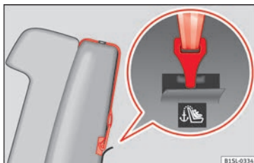
Fig. 27 Ejemplo de un cinturón de fijación superior enganchado.
