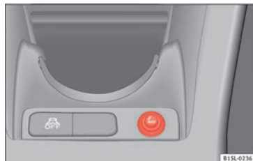
Fig. 132 En la parte delantera de la consola central: encendedor.
