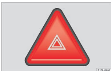
Fig. 110 Tablero de instrumentos: tecla para encender y apagar los intermitentes de emergencia.
