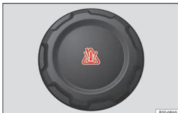
Fig. 171 En el vano motor: Tapón del depósito de expansión del líquido refrigerante.
