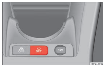
Fig. 176 Consola central: tecla del sistema de control de los neumáticos
