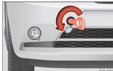
Fig. 81 En la parte derecha del parachoques delantero: enroscar la argolla de remolque.
