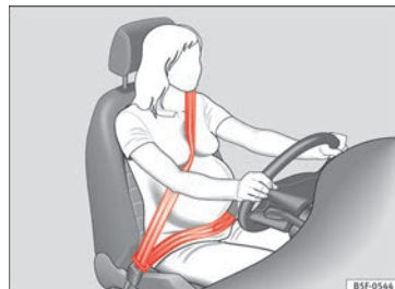
Fig. 73 Colocación de la banda del cinturón en el caso de mujeres embarazadas.
