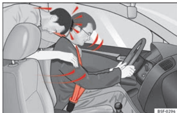
Fig. 71 El ocupante del asiento trasero que no lleve puesto el cinturón de seguridad se verá lanzado hacia delante sobre el conductor que sí lleva el cinturón.
