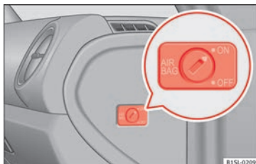
Fig. 75 En el lado del acompañante: interruptor de llave para activar y desactivar el airbag frontal del acompañante.
