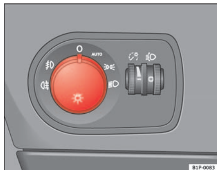
Fig. 75 Encendido automático de luces
