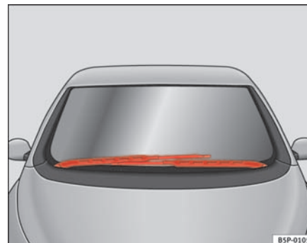
Fig. 158 Limpiacristales en la posición para realizar el cambio
