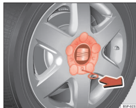
Fig. 165 Cambio de rueda: Retirar el embellecedor de la rueda
