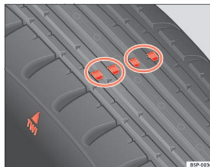
Fig. 162 Indicadores de desgaste del perfil del neumático
