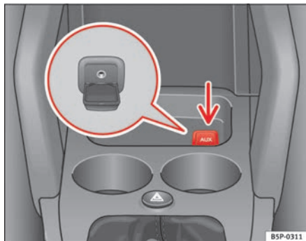
Fig. 118 Conector para la entrada auxiliar de audio
