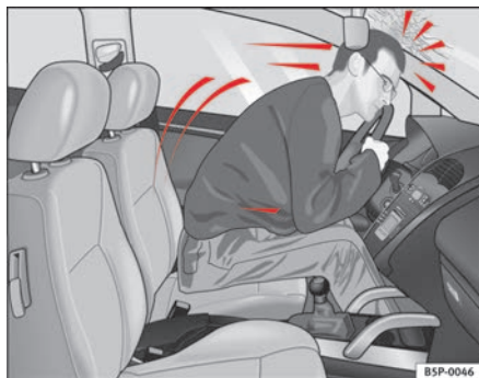
Fig. 9 El conductor que no lleve puesto el cinturón de seguridad se verá lanzado hacia adelante
