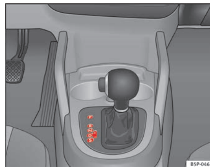
Fig. 139 Consola central: palanca selectora del cambio automático / cambio automático DSG
