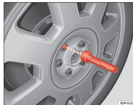
Fig. 172 Cambio de rueda: Útil de hexágono interior para girar los tornillos
