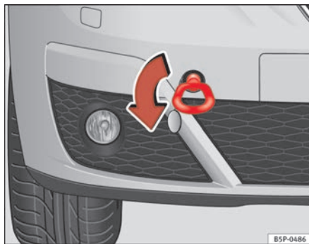
Fig. 198 Atornillado de la argolla de remolque en la parte delantera derecha del vehículo
