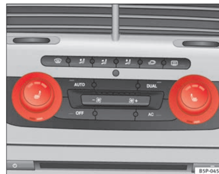
Fig. 95 Calefacción asientos delanteros con Climatronic
