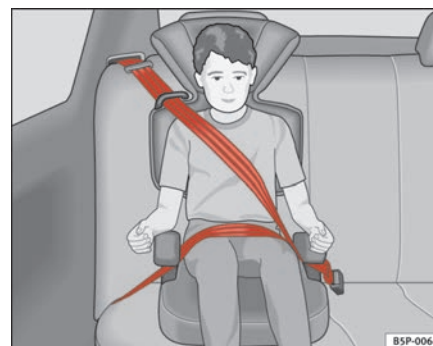
Fig. 30 Asiento para niños montado en el asiento trasero en la dirección de la marcha.
