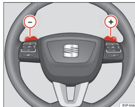
Fig. 144 Volante con palancas para cambio automático
