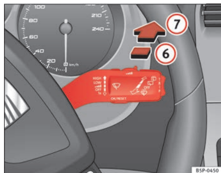
Fig. 87 Palanca del limpia-lavacristales: limpiacristales
