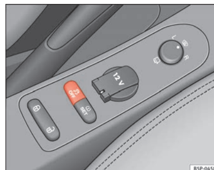
Fig. 135 Detalle de la consola central: tecla ESP
