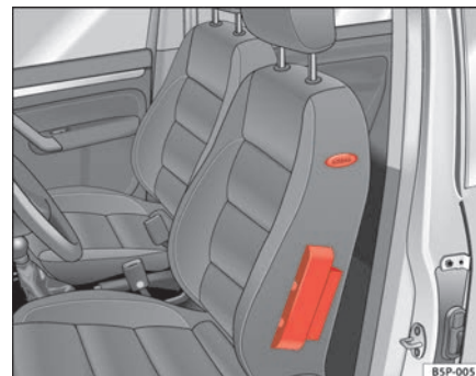
Fig. 22 Airbag lateral en el asiento del conductor
