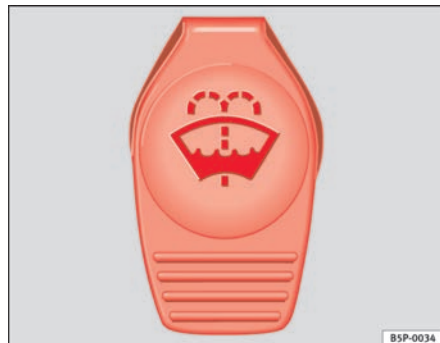
Fig. 159 Tapón del depósito del lavacristales en el vano motor.
