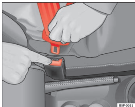
Fig. 16 Retirar la lengüeta del cierre del cinturón
