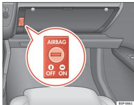
Fig. 26 En la guantera: conmutador con llave para activar y desactivar el airbag del acompañante
