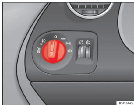
Fig. 73 Encendido automático de luces
