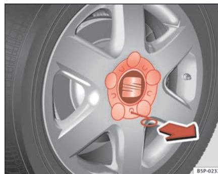
Fig. 168 Cambio de rueda: Retirar el embellecedor de la rueda
