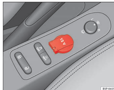
Fig. 117 Toma de corriente consola central delantera
