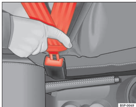
Fig. 12 Cierre y lengüeta del cinturón de seguridad
