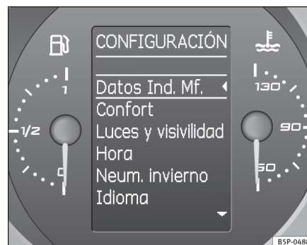
Fig. 47 Pantalla del cuadro de instrumentos indicador multifunción (MFA).
