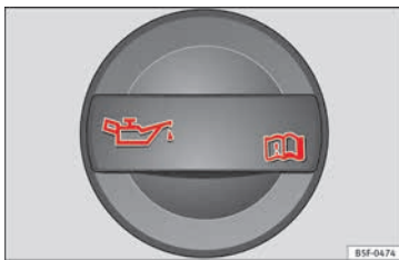
Fig. 50 Tapón de la boca de llenado de aceite del motor en el vano motor.
