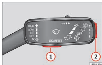
Fig. 35 Palanca del limpiaparabrisas: teclas de control.
