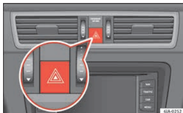
Fig. 133 Cuadro de instrumentos: conmutador de los intermitentes de emergencia.
