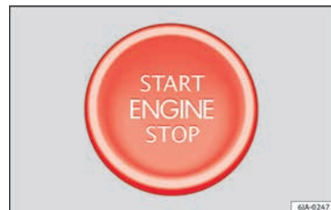
Fig. 173 En la columna de dirección: pulsador de arranque del sistema de cierre y arranque sin llave Keyless Access. En los vehículos con el volante a la derecha, la disposición es simétrica.
