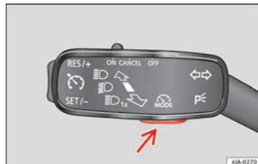
Fig. 191 En la palanca de intermitentes y de luz de carretera: tecla para los sistemas de asistencia al conductor.
