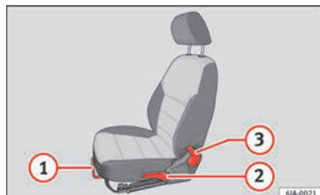
Fig. 9 Asientos delanteros: ajuste manual del asiento.
