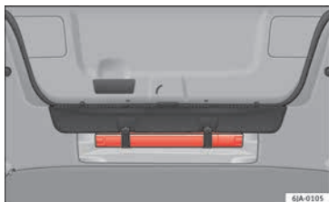
Fig. 82 Emplazamiento del triángulo de preseñalización.
