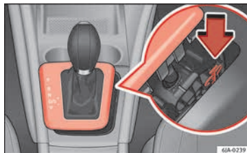
Fig. 44 Desbloqueo de emergencia de la palanca selectora.
