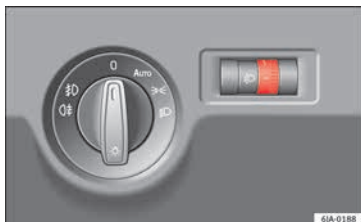
Fig. 130 Cuadro de instrumentos: regulación del alcance de las luces.
