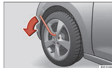
Fig. 62 Cambio de rueda: aflojar los tornillos de rueda.
