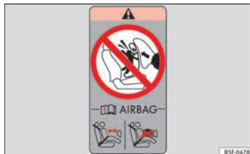
Fig. 23 En el marco posterior de la puerta del acompañante: adhesivo relativo al airbag.
