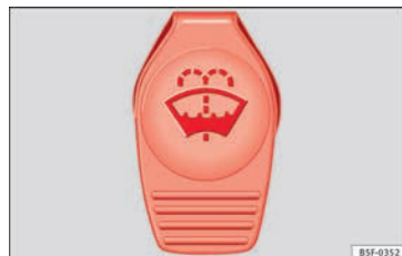
Fig. 53 En el vano motor: tapón del depósito del limpiacristales.
