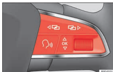
Fig. 36 Lado derecho del volante multifunción: teclas de control.
