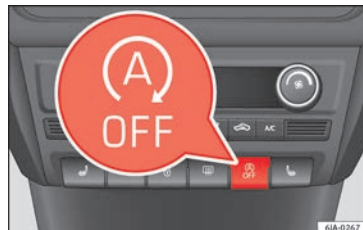
Fig. 192 Cuadro de instrumentos: tecla del sistema Start-Stop.
