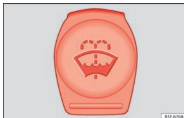
Fig. 54 En el vano motor: tapón del depósito del limpiacristales.
