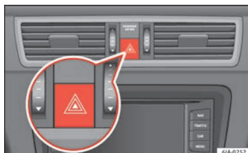
Fig. 29 Tablero de instrumentos: conmutador de los intermitentes de emergencia.
