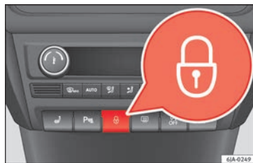
Fig. 123 Pulsador del cierre centralizado.
