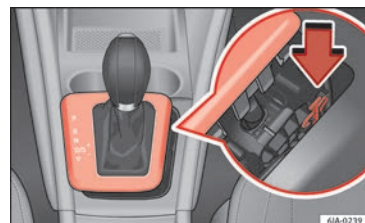
Fig. 45 Desbloqueo de emergencia de la palanca selectora.
