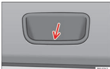
Fig. 129 Detalle del guarnecido interior del portón trasero: cavidad para tirar.
