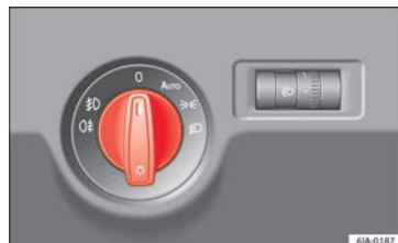
Fig. 131 Cuadro de instrumentos: mando de las luces.
