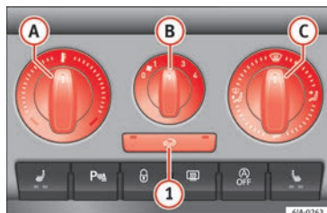
Fig. 48 En la consola central: mandos del sistema de calefacción y aire fresco.
