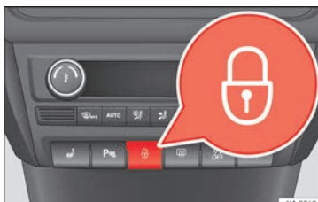
Fig. 2 Consola central: conmutador del cierre centralizado.
