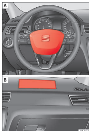
Fig. 15 Airbag del conductor en el volante y airbag del acompañante en el tablero de instrumentos.
