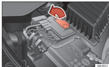
Fig. 210 Batería: apertura de la cubierta.
