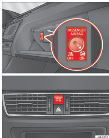
Fig. 82 Conmutador del airbag frontal del acompañante/testigo para desconexión de airbag del acompañante.
