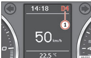
Fig. 179 Pantalla informativa: posiciones de la palanca selectora.
