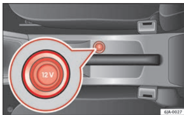
Fig. 156 Consola central: toma de corriente 12 V.
