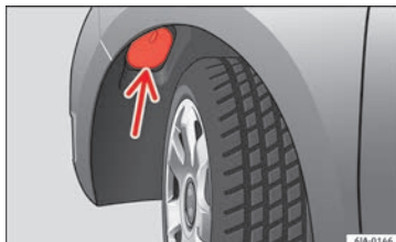
Fig. 92 Cambio de lámpara de la luz de cruce: pasarruedas.
