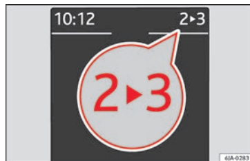
Fig. 38 Cuadro de instrumentos: indicación de las marchas (cambio manual).
