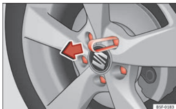
Fig. 61 Retirar la tapa del tornillo de la rueda.
