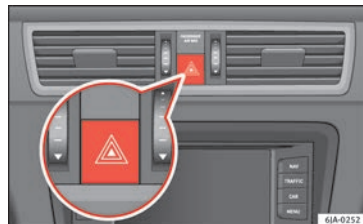
Fig. 135 Cuadro de instrumentos: conmutador de los intermitentes de emergencia.
