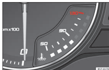
Fig. 113 Cuadro de instrumentos: indicador de la temperatura del líquido refrigerante
