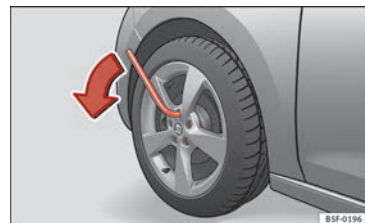
Fig. 63 Cambio de rueda: aflojar los tornillos de rueda.
