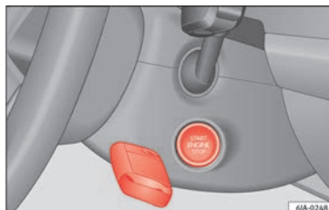
Fig. 175 Arranque de emergencia en vehículos con Keyless Access.
