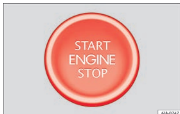
Fig. 174 En la columna de dirección: pulsador de arranque del sistema de cierre y arranque sin llave Keyless Access. En los vehículos con el volante a la derecha, la disposición es simétrica.
