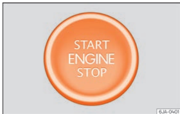
Fig. 212 En la columna de dirección: pulsador de arranque del sistema de cierre y arranque sin llave Keyless Access. En los vehículos con el volante a la derecha, la disposición es simétrica.
