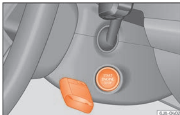
Fig. 213 Arranque de emergencia en vehículos con Keyless Access.
