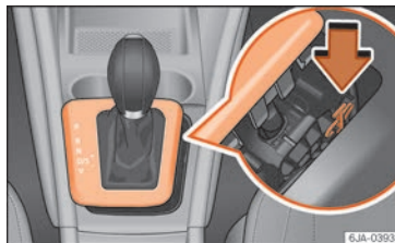
Fig. 45 Desbloqueo de emergencia de la palanca selectora.
