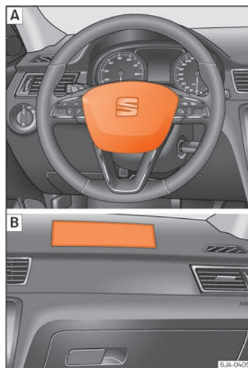
Fig. 18 Airbag del conductor en el volante y airbag del acompañante en el tablero de instrumentos.
