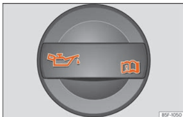
Fig. 51 Tapón de la boca de llenado de aceite del motor en el vano motor.
