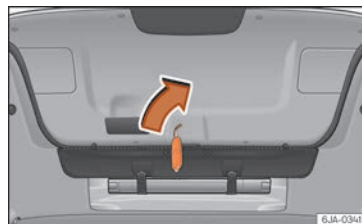
Fig. 8 Detalle del maletero: acceso al desbloqueo de emergencia.
