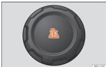
Fig. 52 Vano motor: tapón del depósito de expansión del líquido refrigerante.
