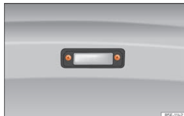
Fig. 108 Desmontaje de la iluminación placa matrícula.
