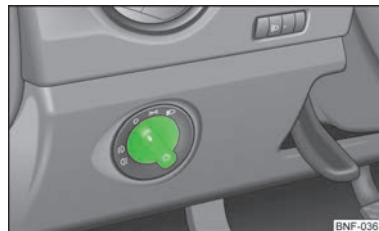
Fig. 21 Cuadro de interruptores: Conmutador luz
