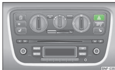
Fig. 24 Cuadro de interruptores: Interruptor para el sistema de intermitentes simultáneos
