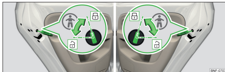
Fig. 32 Puerta posterior: Conectar/desconectar el seguro para niños
