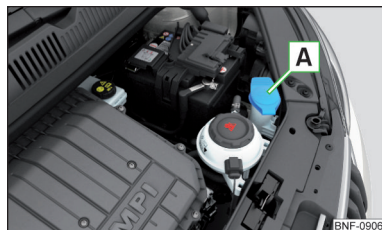
Fig. 140 Depósito de agua del lavacristales
