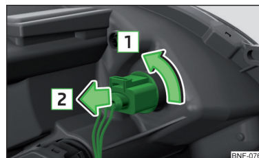
Fig. 173 Cambiar la bombilla de conducción diurna y de posición
