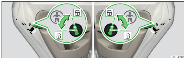
Fig. 33 Puerta posterior: Conectar/desconectar el seguro para niños
