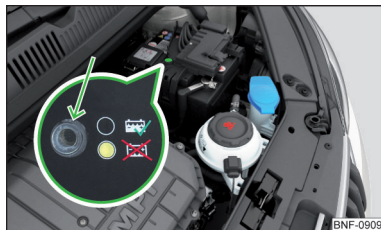
Fig. 144 Batería del vehículo: Indicador del nivel de ácido
