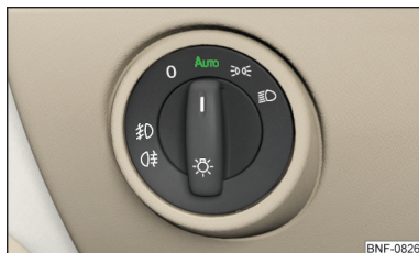
Fig. 42 Conmutador de luces: Posición AUTO
