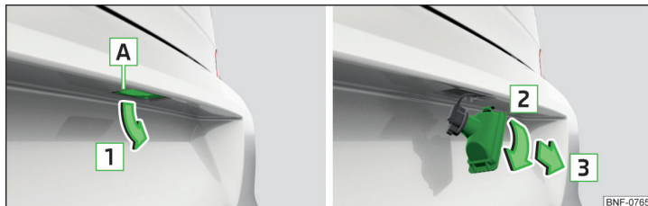
Fig. 178 Retirar la luz de matrícula
