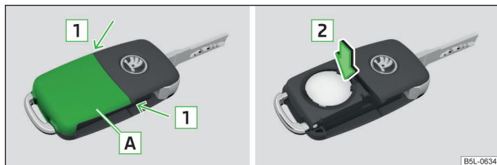
Fig. 160 Desmontar la tapa / extraer la pila
