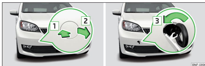
Fig. 159 Retirar la caperuza / instalar la argolla de remolque
