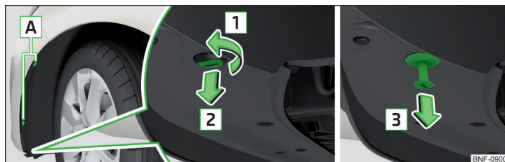
Fig. 176 Retirar el revestimiento de pasarruedas
