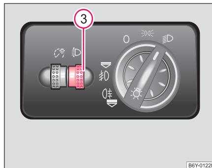
Fig. 31 Cuadro de interruptores: Regulación del alcance luminoso de los faros
