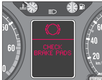
Fig. 15 Display de información: Forro de frenos desgastado
