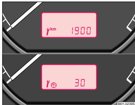
Fig. 5 Indicadores de intervalos de mantenimiento QG1 y QG2
