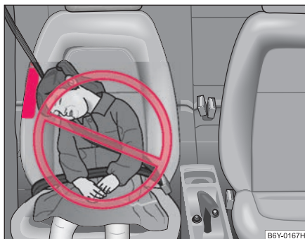
Fig. 107 Niño indebidamente asegurado en una posición de asiento incorrecta - expuesto al peligro a causa del airbag lateral
