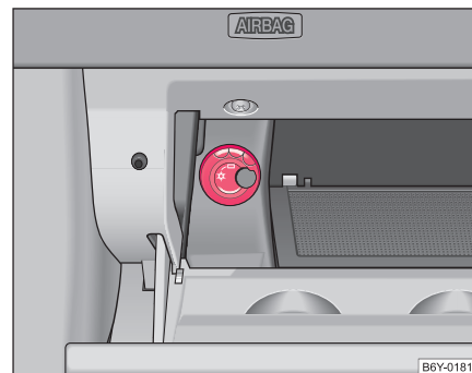
Fig. 71 Compartimento guardaobjetos: manejo de la refrigeración
