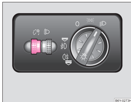
Fig. 33 Cuadro de interruptores: Iluminación de los instrumentos
