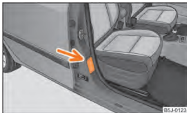
Fig. 110 Adhesivo en el montante central de la carrocería, lado del acompañante
