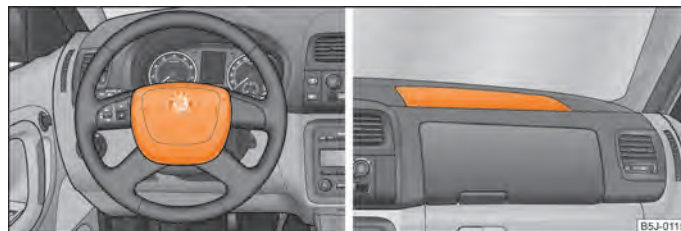
Fig. 102 Airbag del conductor en el volante/airbag del acompañante en el cuadro de instrumentos
