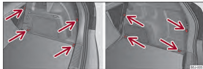
Fig. 44 Maletero: Argollas de amarre y elementos de fijación (Fabia)/(Combi)
