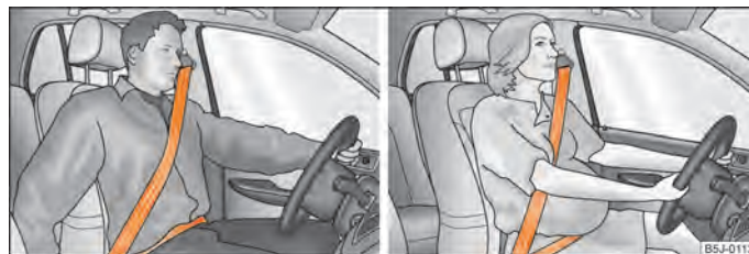
Fig. 99 Colocación de la banda del cinturón en la zona de los hombros y la pelvis/colocación de la banda del cinturón en el caso de mujeres embarazadas
