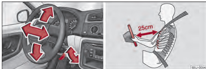
Fig. 81 Volante regulable: Palanca debajo de la columna de dirección/distancia segura desde el volante
