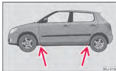
Fig. 143 Cambio de rueda: Puntos de apoyo del gato
