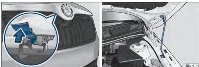
Fig. 127 Rejilla del radiador: Palanca de seguridad/seguro del capó con la varilla de apoyo
