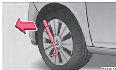
Fig. 140 Desmontar el tapacubos integral
