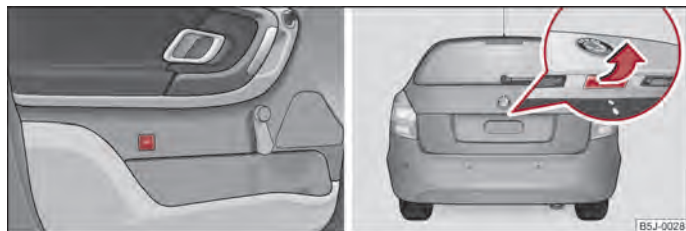
Fig. 15 Desbloqueo la tapa del maletero/asidero de la tapa del maletero
