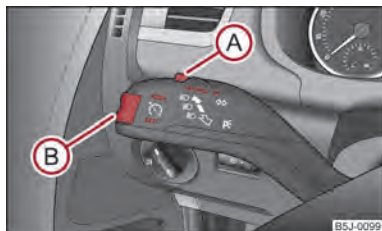
Fig. 86 Palanca de mando: Balancín y conmutador del sistema regulador de la velocidad
