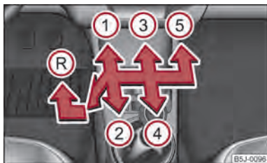
Fig. 83 Esquema de cambio de marchas en vehículos con cambio manual de 5 marchas
