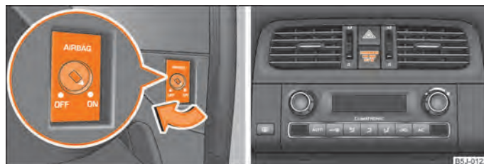
Fig. 109 Conmutador para airbag frontal del acompañante/testigo para desconexión de airbag del acompañante
