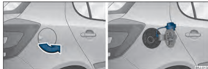
Fig. 125 Parte trasera del vehículo, lado derecho: Tapa del depósito/tapa del depósito con el tapón desenroscado
