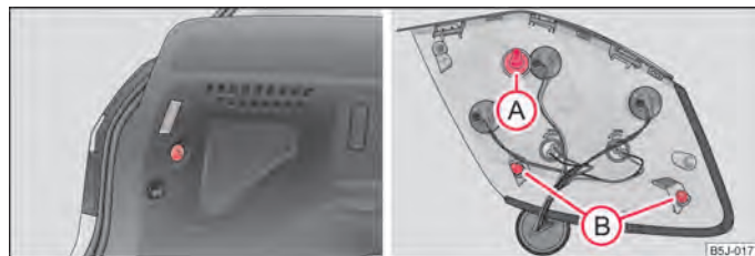
Fig. 165 Desmontar la unidad de luces posteriores/montar la unidad de luces posteriores
