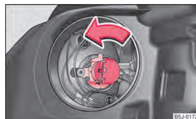
Fig. 160 Desmontaje de la bombilla para luz de carretera
