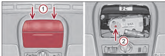
Fig. 21 Escotadura del revestimiento interior del techo: Puntos de apoyo del destornillador / orificio para apoyar la llave
