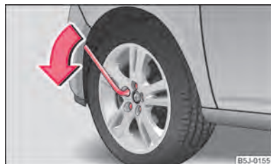
Fig. 142 Cambio de rueda: Aflojar los tornillos de rueda
