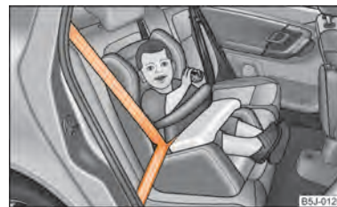
Fig. 113 Asiento infantil instalado en dirección de la marcha con mesa de seguridad del grupo 1 en el asiento trasero
