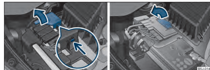
Fig. 132 Batería: Levantar la tapa (cambio automático)/(cambio manual)
