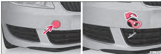
Fig. 149 Paragolpes delantero: Cubierta/montaje de la argolla de remolque
