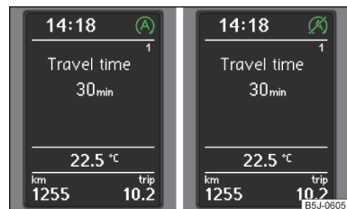
Fig. 115 Pantalla MAXI DOT: El motor está automáticamente apagado / no es posible el apagado automático del motor
