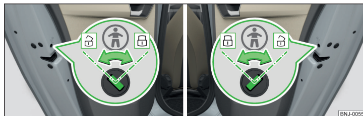
Fig. 35 Puerta posterior: Conectar/desconectar el seguro para niños
