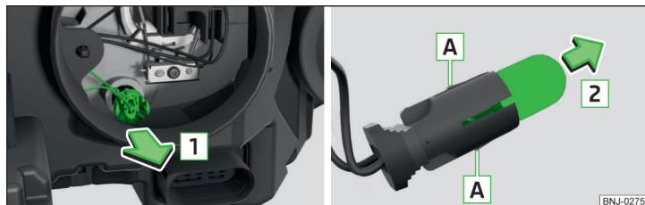
Fig. 210 Cambiar la bombilla de la luz de población
