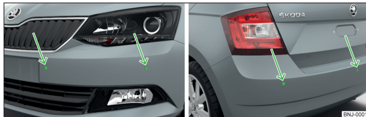
Fig. 127 Lugar de instalación de los sensores del lado izquierdo del vehículo: delantero / trasero
