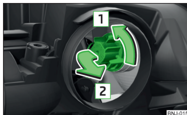
Fig. 209 Cambiar la bombilla para luz intermitente delantera
