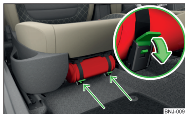
Fig. 269 Soltar el extintor de incendios
