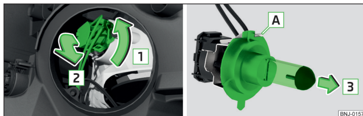
Fig. 302 Cambiar la bombilla de la luz de cruce
