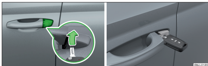
Fig. 283 Tirador en la puerta del conductor: Abrir el cubrimiento del cerrador / Bombín de cierre con llave
