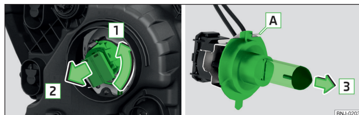
Fig. 303 Cambiar la bombilla de la luz de carretera.
