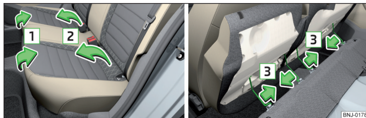
Fig. 71 Abatir el asiento trasero / Retirar el asiento trasero dividido
