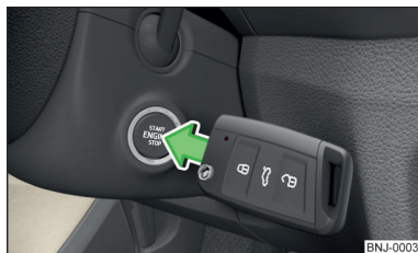
Fig. 207 Dejar el motor encendido - Presionar el botón con la llave
