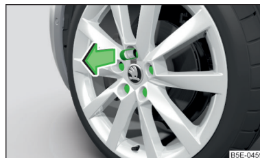
Fig. 272 Retirar la caperuza protectora
