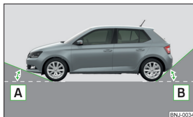
Fig. 310 Ángulo de desplome
