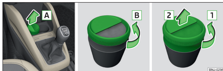
Fig. 96 Retirar/abrir/desarmar el cenicero
