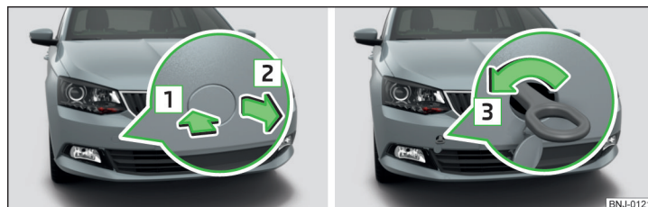
Fig. 280 Retirar la caperuza / instalar la argolla de remolque
