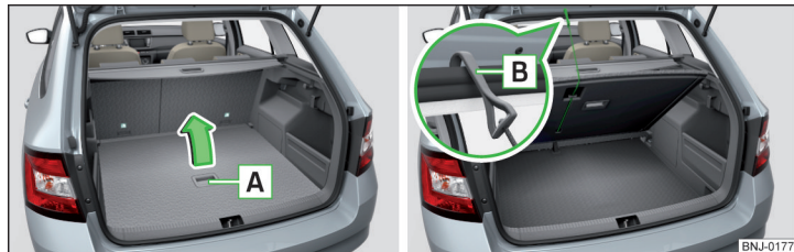
Fig. 117 Subir el suelo de carga variable / fijar el suelo de carga variable
