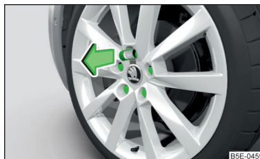
Fig. 261 Retirar la caperuza protectora
