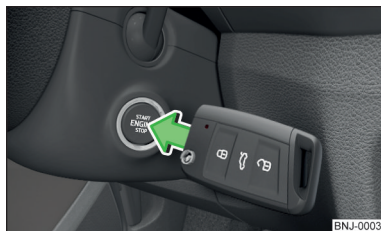
Fig. 193 Dejar el motor encendido - Presionar el botón con la llave
