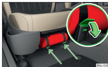
Fig. 258 Soltar el extintor de incendios
