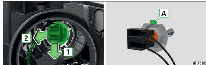
Fig. 288 Sustituir la bombilla para luz de cruce y de carretera
