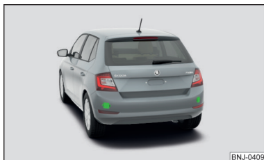
Fig. 210 Lugar de instalación de los sensores de radar
