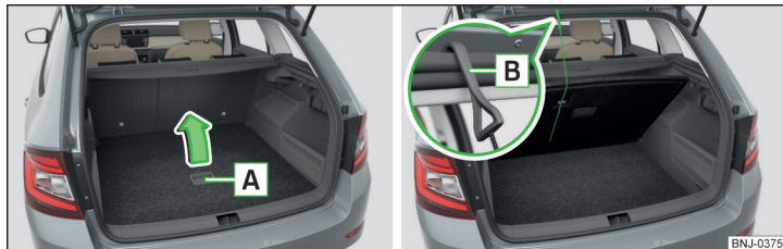
Fig. 120 Subir el suelo de carga variable / fijar el suelo de carga variable
