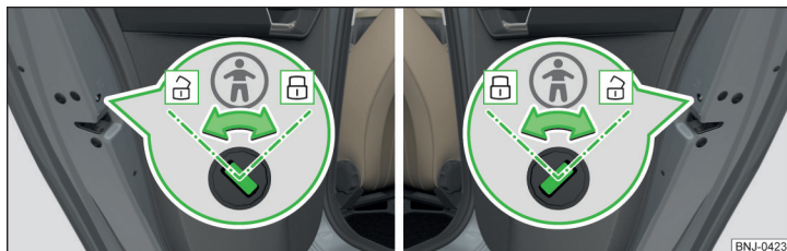
Fig. 49 Puerta posterior: Conectar/desconectar el seguro para niños
