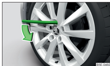
Fig. 263 Aflojar los tornillos de rueda
