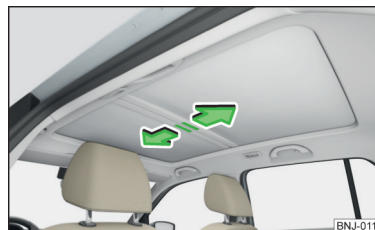
Fig. 64 Abrir la cortinilla antisolar enrollable
