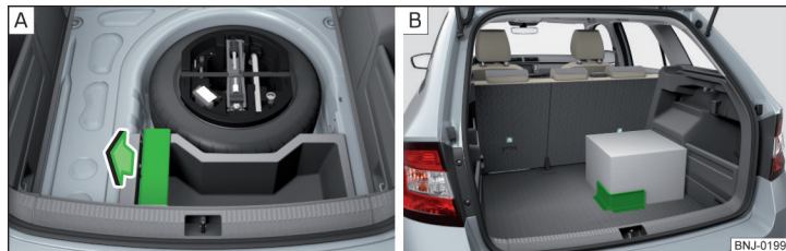
Fig. 113 Retirar el elemento Cargo / Ejemplo de fijación de la carga
