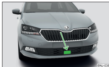
Fig. 203 Lugar de instalación del sensor de radar
