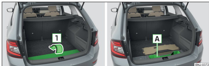
Fig. 115 Abatir el suelo / compartimento guardaobjetos debajo del suelo
