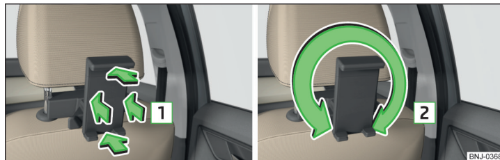
Fig. 101 Voltear y girar el soporte
