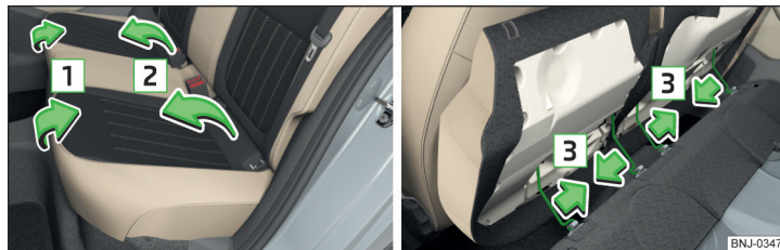
Fig. 72 Abatir el asiento trasero / Retirar el asiento trasero dividido
