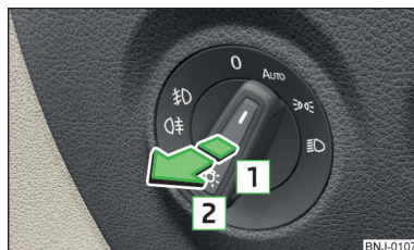
Fig. 58 Conmutador de luces - Encender los faros antiniebla/luz trasera antiniebla
