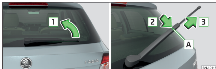
Fig. 279 Reemplazar la escobilla limpiacristales de la luna trasera
