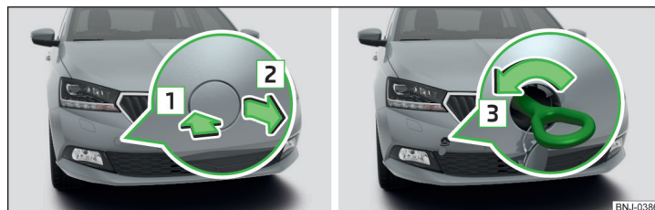
Fig. 269 Retirar la caperuza / instalar la argolla de remolque
