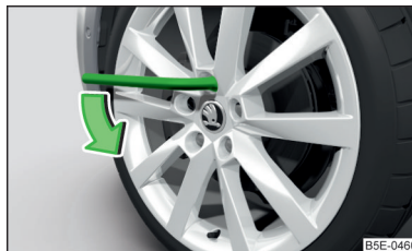
Fig. 322 Aflojar los tornillos de rueda
