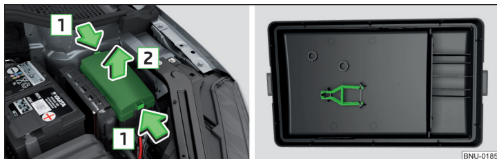
Fig. 344 Tapa de la caja de fusibles: Retirar la tapa / abrazadera plástica para fusibles
