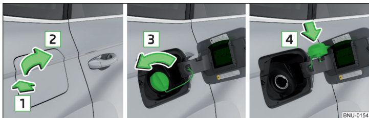
Fig. 302 Abrir la tapa del depósito/ desenroscar el cierre del depósito/ colocar el cierre del depósito en la tapa del depósito
