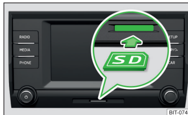
Fig. 190 Swing: Introducir tarjeta SD
