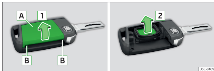
Fig. 330 Abrir la tapa / Extraer la pila
