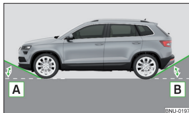
Fig. 357 Ángulo de desplome
