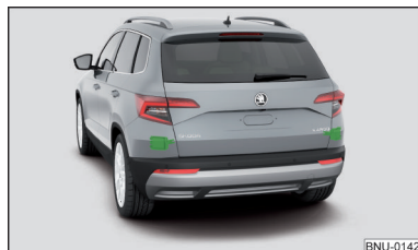
Fig. 266 Lugar de instalación de los sensores de radar
