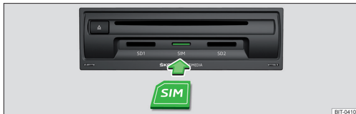
Fig. 198 Introducir la tarjeta SIM en el módulo externo
