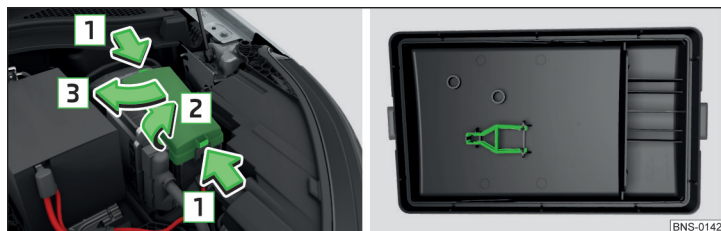
Fig. 368 Tapa de la caja de fusibles: Retirar la tapa / abrazadera plástica para fusibles
