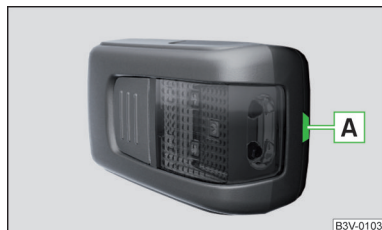
Fig. 355 Clip de cierre en la tapa de la pila recargable
