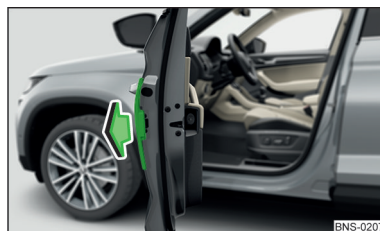
Fig. 56 Retirar borde de protección
