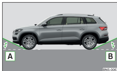
Fig. 382 Ángulo de desplome
