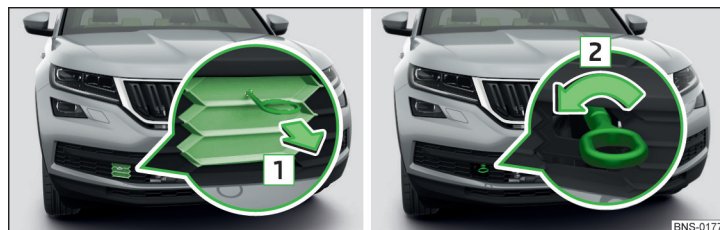
Fig. 349 Retirar la reja de protección / Instalar la argolla de remolque
