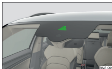
Fig. 312 Sensor para el reconocimiento de las señales de tráfico
