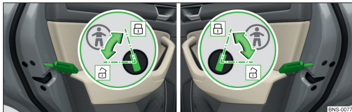
Fig. 58 Puerta posterior: Conectar/desconectar el seguro para niños
