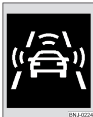
Fig. 307 Pantalla del cuadro de instrumentos combinado: Preaviso y/o frenado de emergencia con baja veloci- dad
