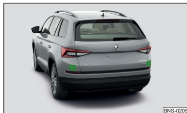
Fig. 272 Lugar de instalación de los sensores de radar
