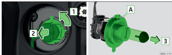
Fig. 371 Cambiar la bombilla de la luz de carretera.
