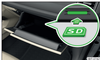
Fig. 195 Columbus, Amundsen, Bolero: Introducir tarjeta SD
