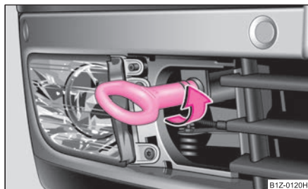
Fig. 219 Paragolpes delantero: montaje de la argolla de remolque
