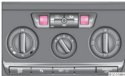
Fig. 70 Cuadro de interruptores: Regulador giratorio para el calentamiento de los asientos delanteros
