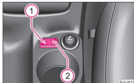
Fig. 27 Consola central: Teclas para cierre centralizado
