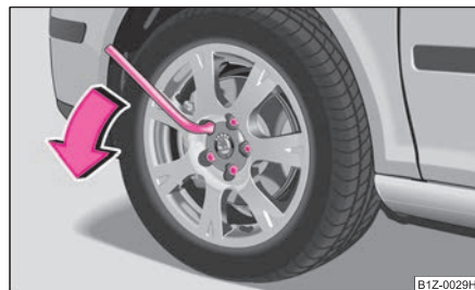
Fig. 214 Cambio de rueda: Aflojar los tornillos de rueda
