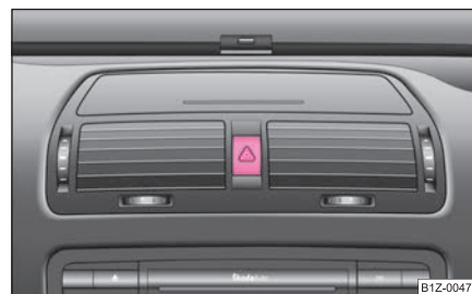
Fig. 44 Cuadro de interruptores: Interruptor para el sistema de intermitentes simultáneos
