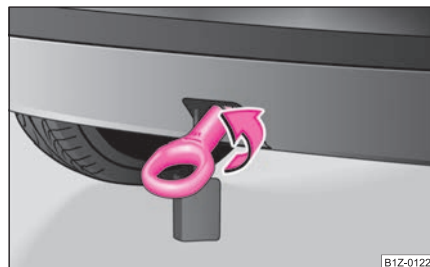
Fig. 221 Paragolpes trasero: montaje de la argolla de remolque
