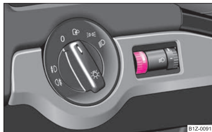
Fig. 42 Cuadro de interruptores: Iluminación de los instrumentos
