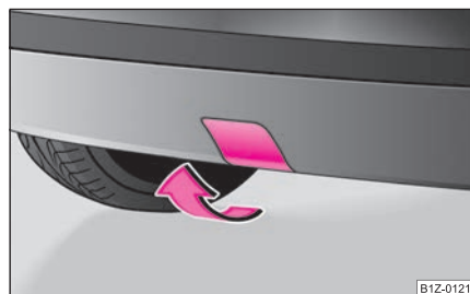
Fig. 220 Paragolpes trasero: desmontar la cubierta
