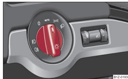
Fig. 57 Cuadro de interruptores: Conmutador de luz
