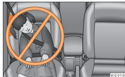
Fig. 188 Niño indebidamente asegurado en una posición de asiento incorrecta – en peligro a causa del airbag lateral
