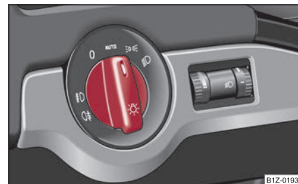
Fig. 8 Cuadro de interruptores: Conmutador de luz
