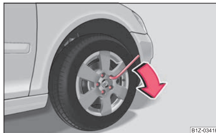
Fig. 227 Cambio de rueda: Aflojar los tornillos de rueda ►
