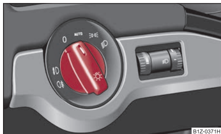
Fig. 56 Cuadro de interruptores: Conmutador de luz
