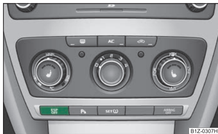
Fig. 197 Interruptor del ESP
