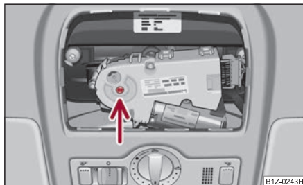
Fig. 55 Escotadura del revestimiento interior del techo: Accionamiento de emergencia
