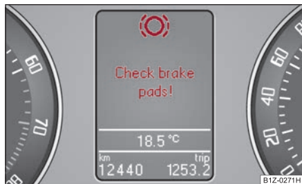
Fig. 34 Display de información: Forro de frenos desgastado
