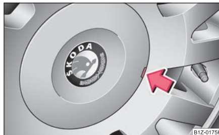
Fig. 226 Retirar el embellecedor de rueda en ruedas de aleación ligera
