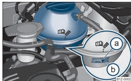
Fig. 213 Vano motor: Depósito de expansión de líquido refrigerante
