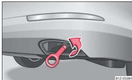
Fig. 234 Paragolpes trasero: montaje de la argolla de remolque
