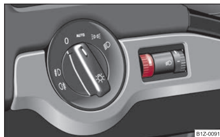
Fig. 59 Cuadro de interruptores: Iluminación de los instrumentos
