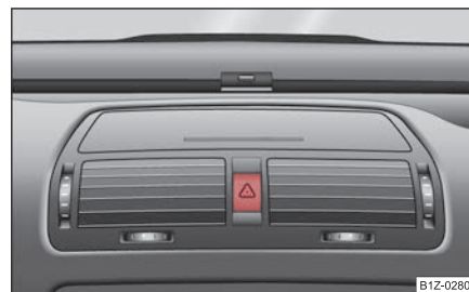
Fig. 61 Cuadro de interruptores: Interruptor para el sistema de intermitentes simultáneos
