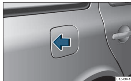
Fig. 206 Parte trasera del vehículo, lado derecho: Tapa del depósito de combustible ►
