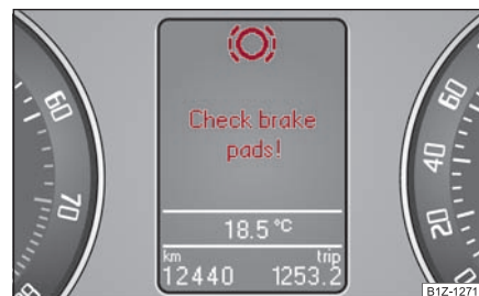
Fig. 33 Pantalla informativa: Forro de frenos desgastado
