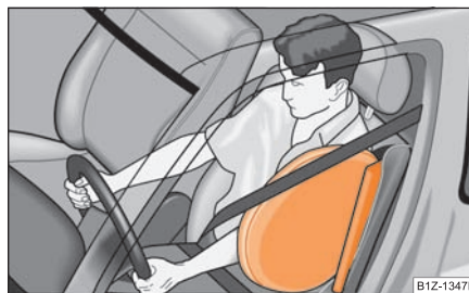
Fig. 181 Airbag lateral lleno de gas
