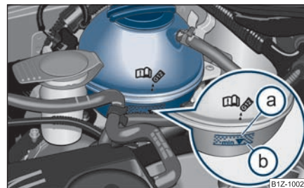
Fig. 212 Vano motor: Depósito de expansión de líquido refrigerante
