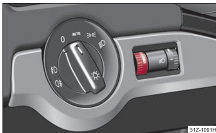
Fig. 57 Cuadro de interruptores: Iluminación de los instrumentos
