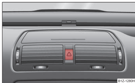
Fig. 59 Cuadro de interruptores: Interruptor para el sistema de intermitentes simultáneos
