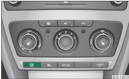
Fig. 196 Interruptor del ESP
