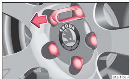
Fig. 225 Retirar la caperuza copertera
