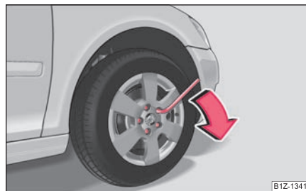
Fig. 227 Cambio de rueda: Aflojar los tornillos de rueda ►
