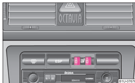
Fig. 63 Cuadro de interruptores: Regulador giratorio para el calefactado de los asientos delanteros
