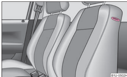
Fig. 121 Lugar de instalación de los airbags laterales en el asiento del conductor
