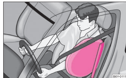
Fig. 122 Airbags laterales rellenos de gas
