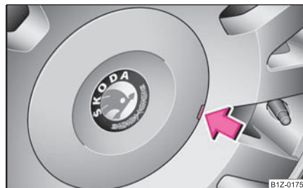
Fig. 162 Retirar el embellecedor de rueda en ruedas de aleación
