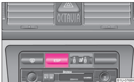
Fig. 134 Interruptor del ESP
