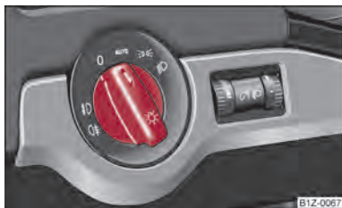
Fig. 24 Cuadro de interruptores: Conmutador luz
