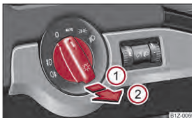
Fig. 26 Cuadro de interruptores: Conmutador luz
