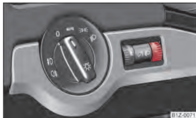
Fig. 28 Cuadro de interruptores: Regulación del alcance luminoso de los faros
