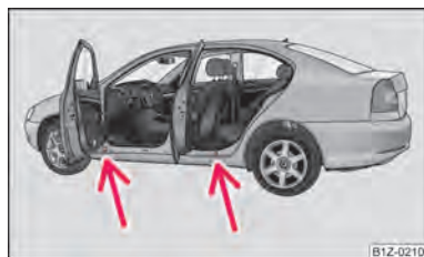
Fig. 167 Cambio de rueda: Puntos de apoyo del gato
