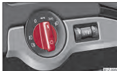
Fig. 25 Cuadro de interruptores: Conmutador luz
