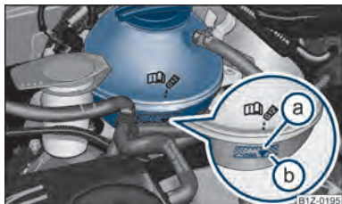
Fig. 152 Vano motor: Depósito de expansión del líquido refrigerante.
