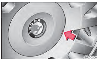
Fig. 165 Retirar el embellecedor de rueda en ruedas de aleación ligera
