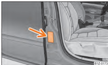
Fig. 130 Adhesivo en el montante central de la carrocería, lado del acompañante
