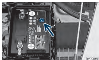
Fig. 155 Batería: Indicación del nivel de electrolitos
