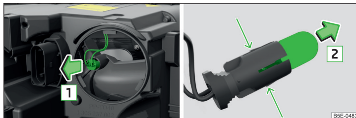
Fig. 246 Faros con luz de xenón: bombilla para la luz de posición adicional
