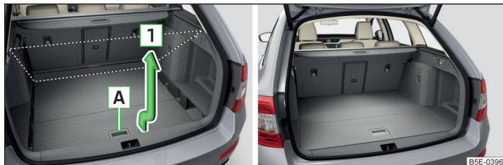
Fig. 126 Ajustar el suelo de carga variable en la posición superior / suelo de carga variable en la posición superior
