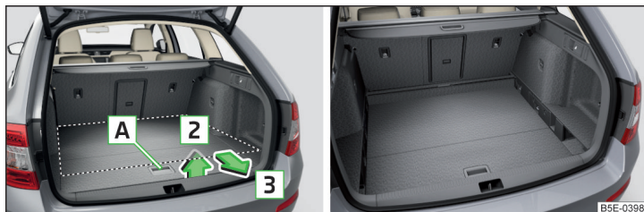
Fig. 127 Ajustar el suelo de carga variable en la posición inferior / suelo de carga variable en la posición inferior
