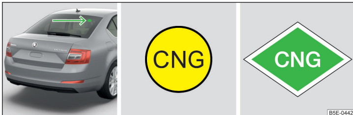
Fig. 202 Posición de la etiqueta adhesiva GNC / etiqueta adhesiva GNC
