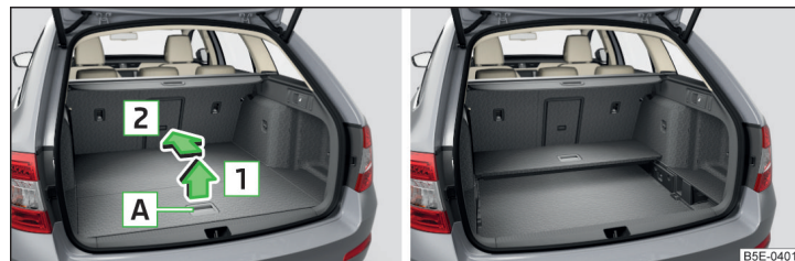
Fig. 128 Plegar el suelo de carga variable / El suelo de carga variable plegado en la posición superior
