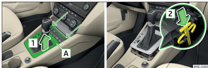
Fig. 235 Desbloqueo de emergencia de la palanca selectora
