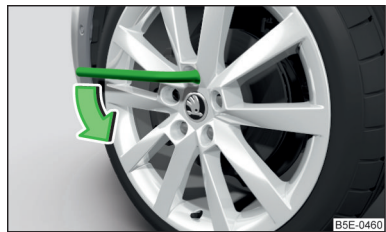
Fig. 220 Cambio de rueda: aflojar los tornillos de rueda
