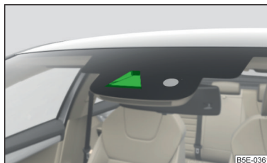
Fig. 57 Mirilla de la cámara para el asistente de luz de carretera
