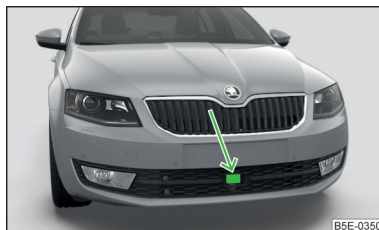
Fig. 154 Lugar de montaje del sensor de radar
