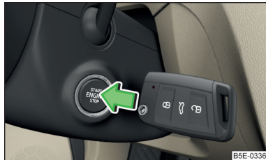
Fig. 144 Dejar el motor encendido - Presionar el botón con la llave
