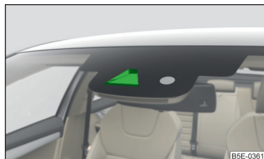
Fig. 181 alcance visual de la cámara para la detección de las señales de tráfico
