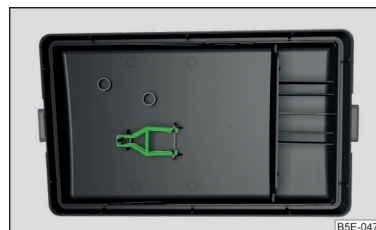
Fig. 242 Tapa de la caja de fusibles en el vano motor: grapa de plástico para fusibles
