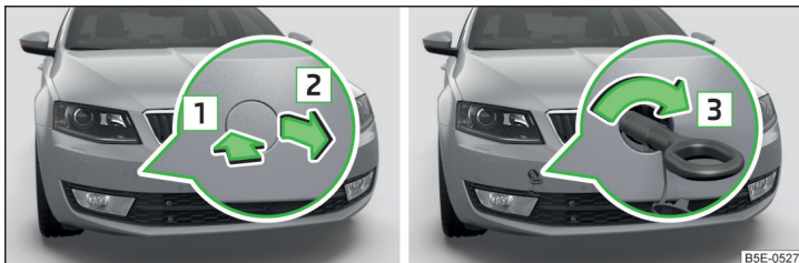
Fig. 227 Desmontaje de la caperuza cobertera / montaje de la argolla de remolque
