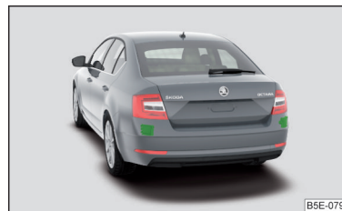
Fig. 256 Lugar de instalación de los sensores de radar
