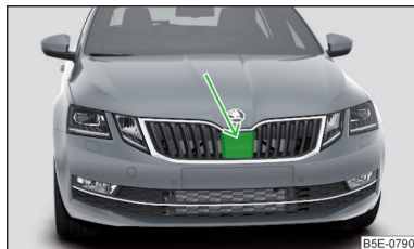
Fig. 248 Lugar de instalación del sensor de radar
