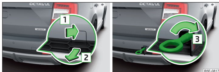
Fig. 339 Retirar la caperuza / Instalar la argolla de remolque - Variante 2
