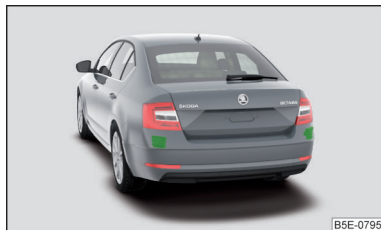
Fig. 259 Lugar de instalación de los sensores de radar
