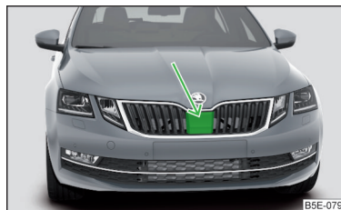
Fig. 251 Lugar de instalación del sensor de radar
