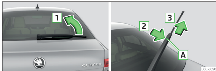
Fig. 350 Reemplazar la escobilla limpiacristales de la luna trasera
