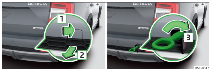
Fig. 340 Retirar la caperuza / Instalar la argolla de remolque - Variante 2
