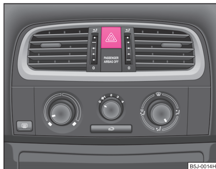
Fig. 36 Cuadro de interruptores: Interruptor para el sistema de intermitentes simultáneos
