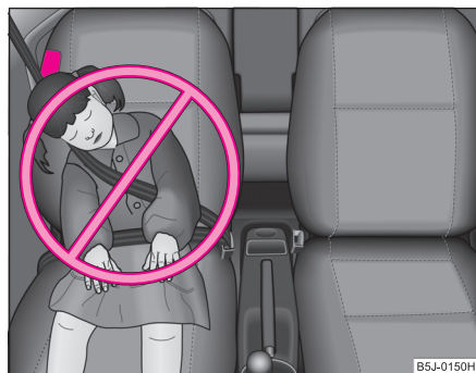
Fig. 136 Niño indebidamente asegurado en una posición de asiento incorrecta - en peligro a causa del airbag lateral
