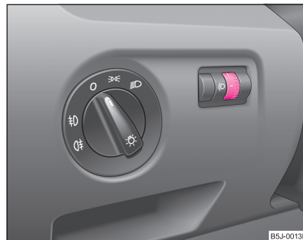
Fig. 35 Cuadro de interruptores: Regulación del alcance luminoso de los faros
