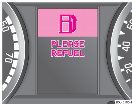
Fig. 14 Display de información: Reserva de combustible baja
