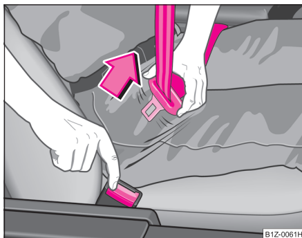
Fig. 124 Retirar la lengüeta del cierre del cinturón
