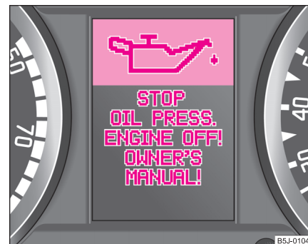
Fig. 13 Display de información: Presión baja del aceite
