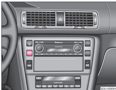
Fig. 164 Interruptor del ESP
