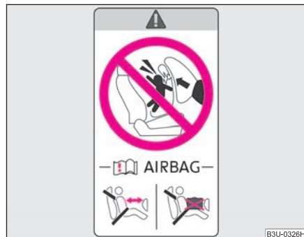
Fig. 155 Adhesivo en el montante central de la carrocería, lado del acompañante
