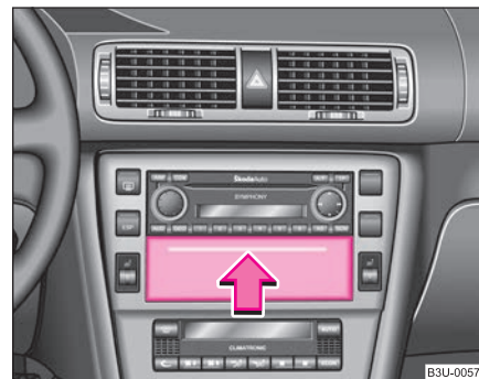
Fig. 96 Cuadro de interruptores: Compartimento guardaobjetos extraíble
