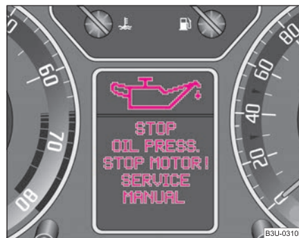
Fig. 14 Display de información: Presión baja del aceite
