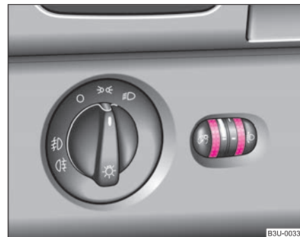
Fig. 38 Cuadro de interruptores: Regulación del alcance luminoso de los faros
