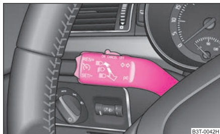
Fig. 47 La palanca de luz intermitente y luz de carretera
