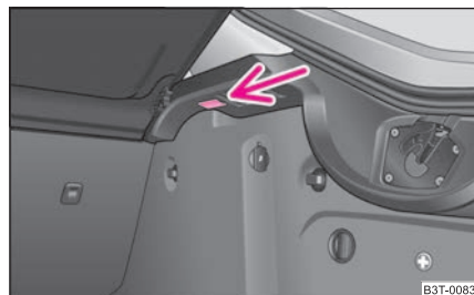
Fig. 227 Desmontar la luz del maletero
