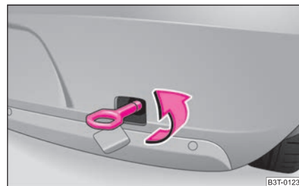
Fig. 211 Paragolpes posterior: montaje de la argolla de remolque
