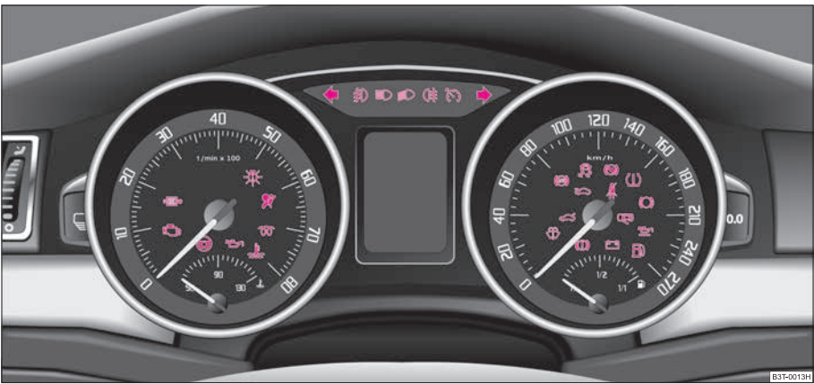
Fig. 21 Cuadro de instrumentos con testigos luminosos
