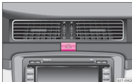
Fig. 46 Tablero de instrumentos: interruptor para los intermitentes simultáneos de emergencia
