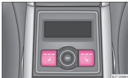
Fig. 72 Consola central posterior: regulador giratorio para el calefactado de los asientos posteriores
