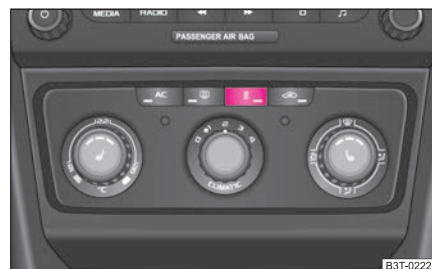
Fig. 118 Tecla de conexión/desconexión directa de la calefacción adicional (calefacción y ventilación independiente) en la unidad de mando Climatic
