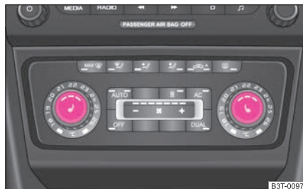
Fig. 71 Tablero de instrumentos: regulador de la calefacción de asientos delanteros
