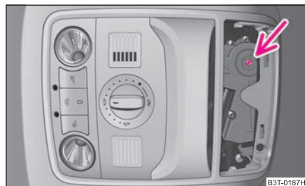
Fig. 40 Sector del revestimiento interior del techo: accionamiento de emergencia
