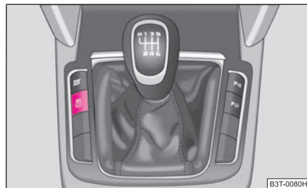
Fig. 177 Tecla para ajustar el valor de control de la presión de inflado de los neumáticos
