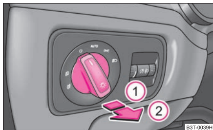
Fig. 41 Tablero de instrumentos: conmutadores de luz
