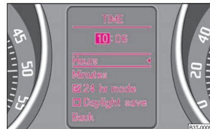
Fig. 19 Ajuste manual de la hora
