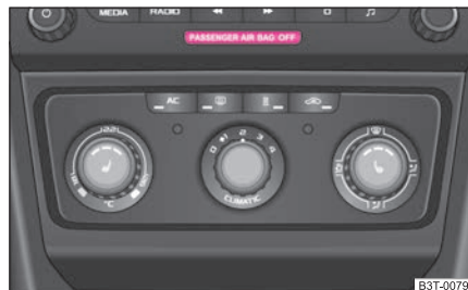
Fig. 164 Testigo para airbag frontal del acompañante
