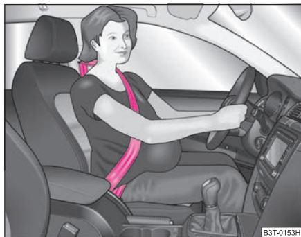
Fig. 151 Colocación del cinturón de seguridad en mujeres embarazadas
