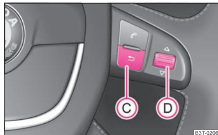
Fig. 7 Indicación multifunción: manejo por medio de las teclas del volante multifunción
