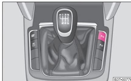
Fig. 125 Activación del aparcamiento asistido
