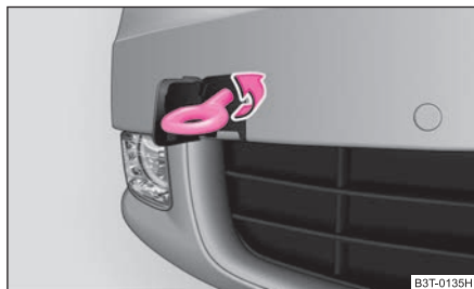
Fig. 209 Paragolpes delantero: montaje de la argolla de remolque
