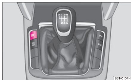
Fig. 175 Interruptor del ESP
