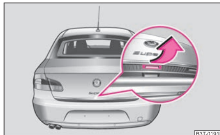
Fig. 29 Tirador de la tapa del maletero
