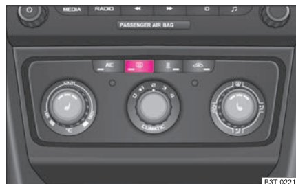
Fig. 54 Interruptor para la calefacción de la luneta trasera térmica
