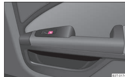
Fig. 37 Posición de montaje del interruptor en la puerta posterior
