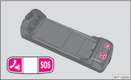
Fig. 140 Tecla para la conexión del mando fónico
