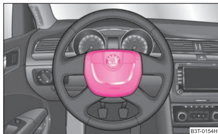
Fig. 154 Airbag del conductor en el volante
