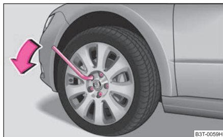
Fig. 204 Cambio de rueda: aflojar los tornillos de rueda
