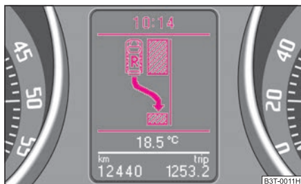
Fig. 130 Pantalla informativa: plaza de aparcamiento reconocida con el aviso a poner la marcha atrás
