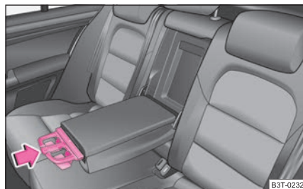
Fig. 86 Apoyabrazos de los asientos posteriores: guardar el soporte de bebidas
