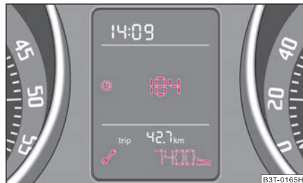
Fig. 4 Indicador de intervalos de mantenimiento: Indicación
