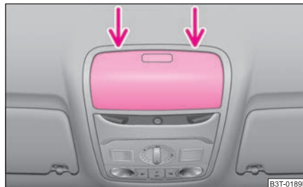
Fig. 39 Sector del revestimiento interior del techo: punto de inicio del destornillador
