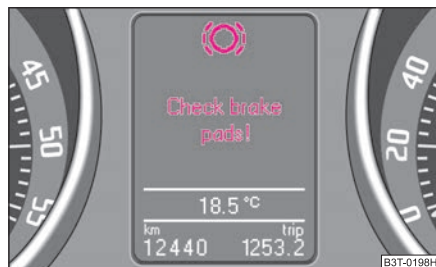
Fig. 18 Pantalla informativa: guarnición de freno desgastado
