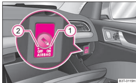
Fig. 163 Portaobjetos Conmutador para el airbag frontal de acompañante
