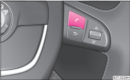
Fig. 141 Volante multifunción: teclas de mando
