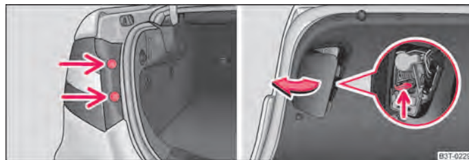
Fig. 207 Desmontaje de la parte exterior de la unidad de luces traseras/desmontaje de la parte interior de la unidad de luces traseras
