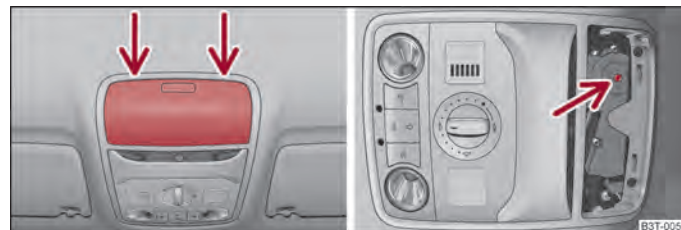
Fig. 30 Escotadura del revestimiento interior del techo/punto de inicio de la llave
