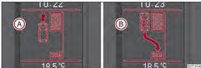
Fig. 123 Pantalla informativa: la plaza de aparcamiento reconocida con un aviso a seguir avanzando (A) y para acoplar la marcha atrás (B)
