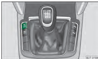
Fig. 161 Sistema ESP: Conmutador para ASR
