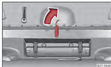
Fig. 23 Desbloqueo de emergencia de la tapa de maletero
