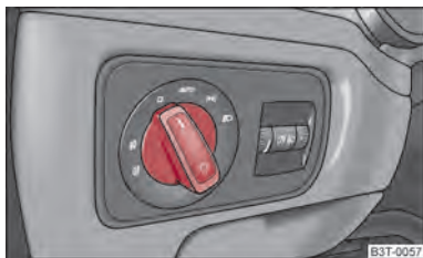
Fig. 34 Cuadro de interruptores: Conmutador luz
