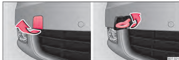
Fig. 196 Paragolpes delantero: Desmontaje de la cubierta/montaje de la argolla de remolque
