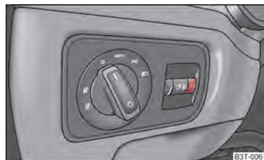
Fig. 38 Cuadro de interruptores: Regulación del alcance luminoso de los faros
