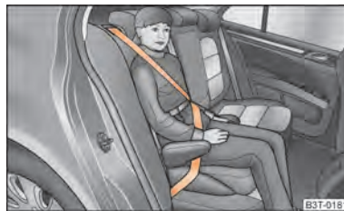
Fig. 158 Asiento infantil del grupo 3 montado en el sentido de marcha sobre el asiento trasero
