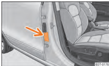
Fig. 153 Adhesivo en el montante central de la carrocería, lado del acompañante
