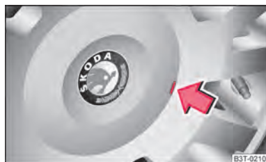
Fig. 187 Retirar el embellecedor de rueda en ruedas de aleación ligera
