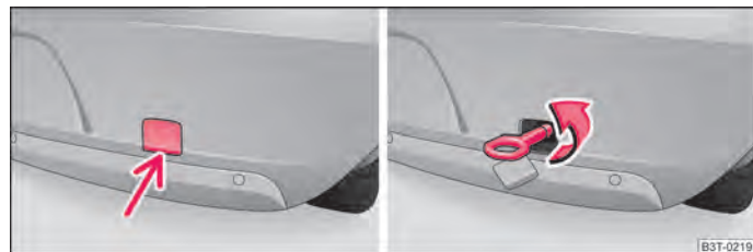
Fig. 197 Paragolpes trasero: Desmontaje de la cubierta/montaje de la argolla de remolque
