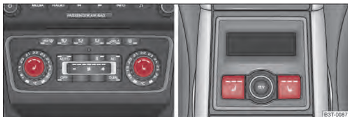
Fig. 64 Cuadro de interruptores: Regulador para calefacción de asientos delanteros/asientos posteriores
