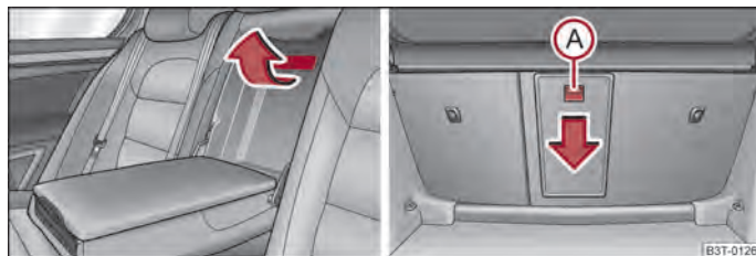
Fig. 103 Asientos traseros: Asidero de la tapa/maletero: Tecla de desbloqueo
