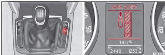
Fig. 122 Activar la indicación del asistente de aparcamiento en la pantalla informativa/pantalla informativa: Encontrar una plaza de aparcamiento adecuada
