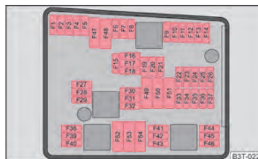
Fig. 200 Representación esquemática de la caja de fusibles en el vano motor - versión 1
