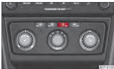
Fig. 112 Tecla de conexión/desconexión directa de la calefacción adicional (calefacción y ventilación independiente) en la unidad de mando del aire acondicionado
