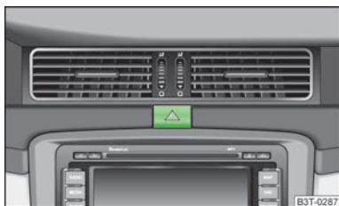
Fig. 35 Cuadro de interruptores: Interruptor para el sistema de intermitentes simultáneos
