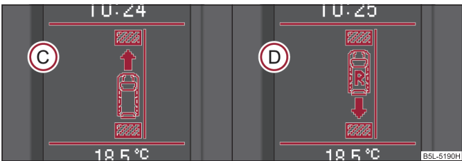
Fig. 121 Pantalla informativa: Aviso para la entrada de la marcha hacia adelante (C) o de la marcha atrás (D)
