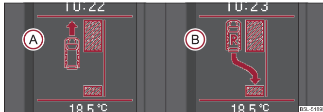
Fig. 120 Pantalla informativa: la plaza de aparcamiento reconocida con un aviso Seguir avanzando (A) y para la entrada de la marcha atrás (B)
