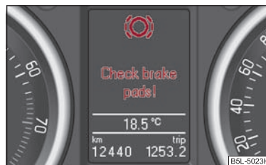
Fig. 27 Pantalla informativa: Forro de frenos desgastado
