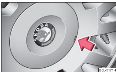
Fig. 185 Retirar el embellecedor de rueda en ruedas de aleación ligera
