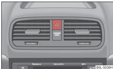
Fig. 49 Cuadro de interruptores: Interruptor para el sistema de intermitentes simultáneos
