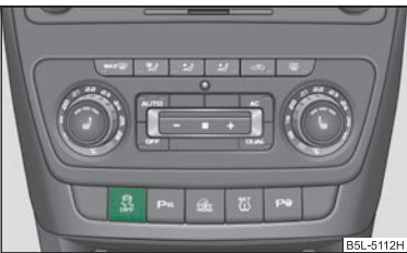
Fig. 154 Interruptor del ESP
