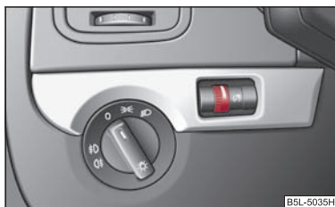
Fig. 47 Cuadro de interruptores: Iluminación de los instrumentos
