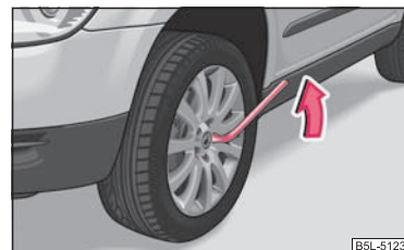
Fig. 186 Cambio de rueda: Aflojar los tornillos de rueda
