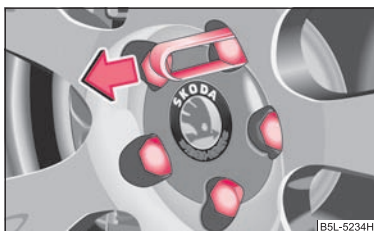
Fig. 184 Retirar la caperuza copertera
