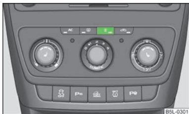
Fig. 92 Tecla de conexión/desconexión directa de la calefacción adicional (calefacción y ventilación independiente) en la unidad de mando del aire acondicionado
