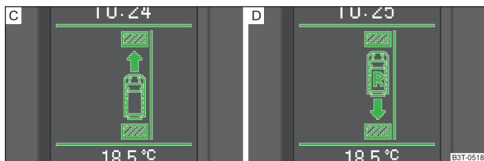
Fig. 104 Pantalla informativa: Indicación para el acoplamiento de la marcha hacia adelante [C] o de la marcha atrás [D]
