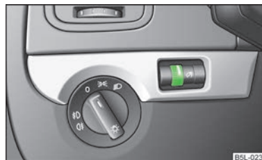
Fig. 26 Cuadro de interruptores: Iluminación de los instrumentos
