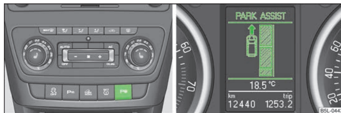
Fig. 102 Activar la indicación del asistente de aparcamiento en la pantalla informativa/pantalla informativa: Búsqueda de una plaza de aparcamiento adecuada
