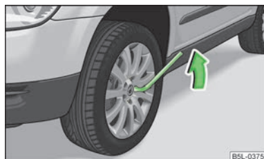
Fig. 156 Cambio de rueda: Aflojar los tornillos de rueda
