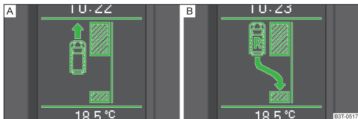
Fig. 103 Pantalla informativa: Plaza de aparcamiento detectada con un aviso a seguir avanzando [A] y para acoplar la marcha atrás [B]
