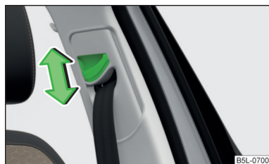
Fig. 140 Asiento delantero: ajuste de la altura del cinturón
