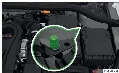
Fig. 180 Punto de masa del motor: sistema START-STOP
