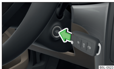
Fig. 107 Arranque de emergencia del motor
