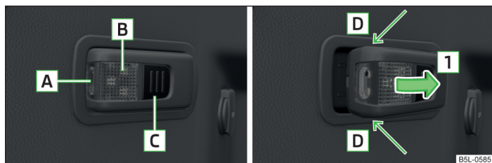
Fig. 86 Manejar la lámpara / extraer la lámpara
