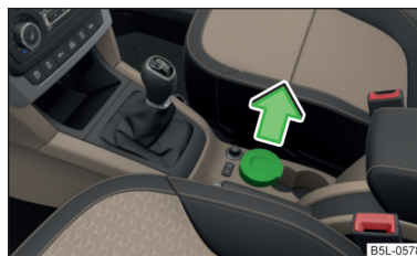
Fig. 62 Extracción del cenicero delantero
