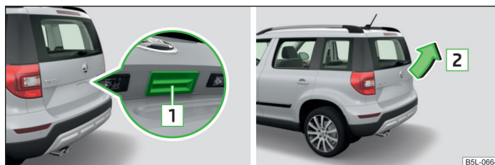
Fig. 19 Tirador de la tapa del maletero / abrir la tapa del maletero
