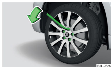
Fig. 174 Cambio de rueda: Aflojar los tornillos de rueda
