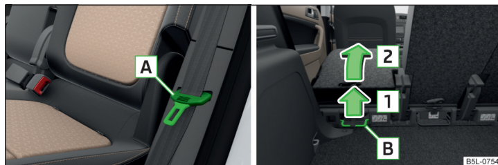
Fig. 67 Posición de seguridad del cinturón / abatir completamente el asiento
