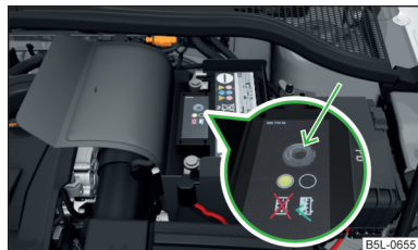
Fig. 156 Batería del vehículo: Indicador del nivel de ácido
