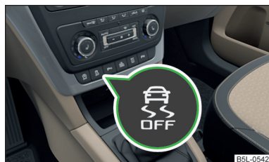
Fig. 127 Tecla del sistema ESC: Active/de-sactive el ASR
