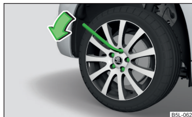
Fig. 166 Cambio de rueda: Aflojar los tornillos de rueda
