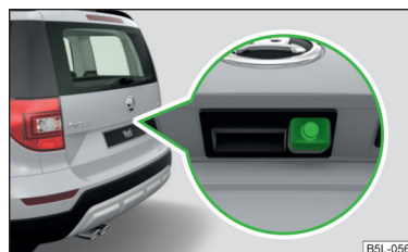
Fig. 131 Lugar de instalación de la cámara
