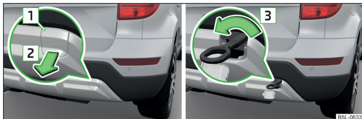
Fig. 174 Desmontaje de la caperuza cobertera / montaje de la argolla de remolque
