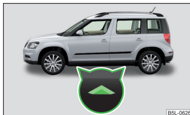
Fig. 167 Puntos de apoyo del gato
