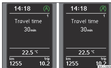
Fig. 137 Pantalla MAXI DOT: El motor está automáticamente apagado / no es posible el apagado automático del motor
