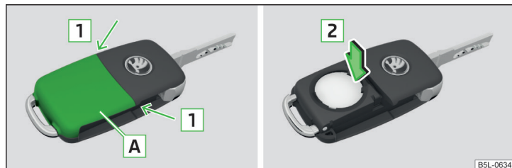
Fig. 175 Desmontar la tapa / extraer la pila
