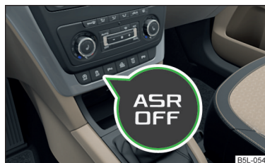
Fig. 128 Tecla del sistema ASR: Active/desactive ASR (vehículo sin ESC)
