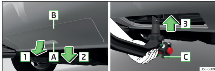
Fig. 142 Extraer la caperuza cobertera situada en el parachoques trasero / aplicar la barra de cabeza esférica
