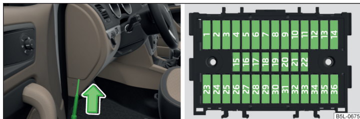
Fig. 184 Tapa de la caja de fusibles en el tablero de instrumentos / fusibles
