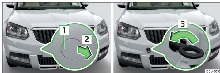
Fig. 173 Desmontaje de la caperuza cobertera / montaje de la argolla de remolque
