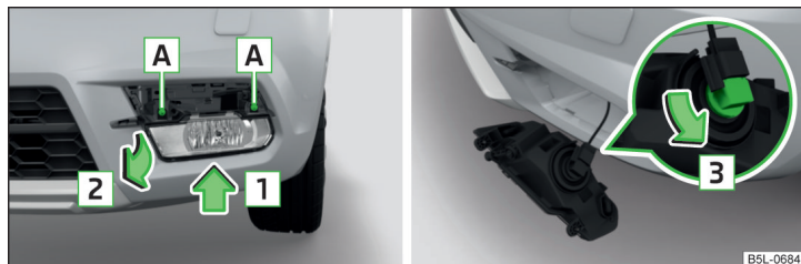
Fig. 191 Imagen esquemática: Desmontar el faro antiniebla / Cambiar la bombilla
