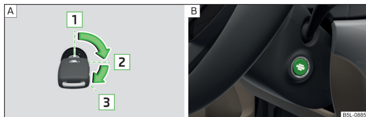
Fig. 121 Posicionamiento de la llave del vehículo en el contacto / Botón de inicio
