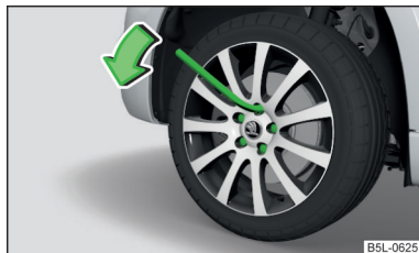
Fig. 174 Aflojar los tornillos de rueda
