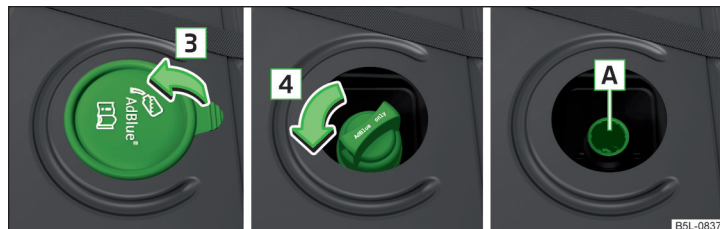
Fig. 157 Levantar el tapón / Desatornillar el tapón del depósito / Soporte de llenado
