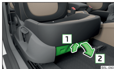
Fig. 89 Abrir el compartimento guardaobjetos
