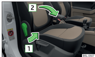
Fig. 58 Abatir el respaldo del acompañante hacia delante
