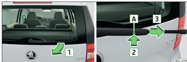
Fig. 191 Reemplazar la escobilla limpiacristales de la luna trasera
