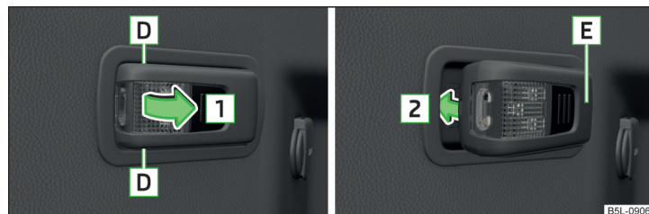
Fig. 110 Luz desmontable: Extraer/introducir
