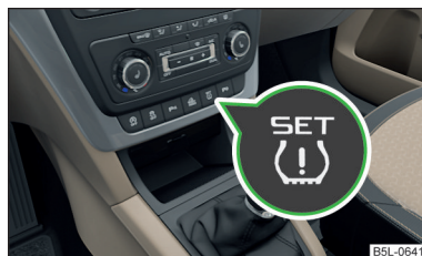
Fig. 142 Tecla para guardar los valores de presión
