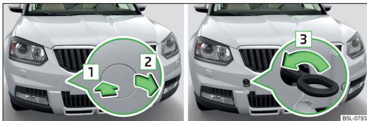
Fig. 180 Retirar la caperuza / instalar la argolla de remolque
