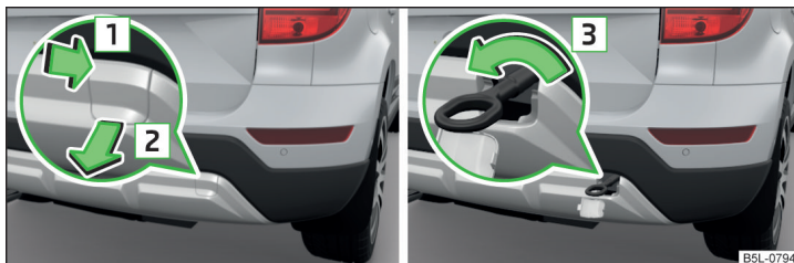
Fig. 181 Retirar la caperuza / instalar la argolla de remolque
