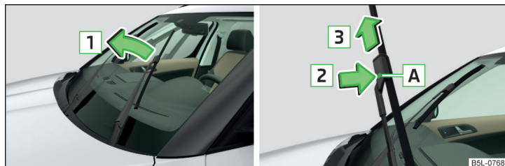
Fig. 190 Cambiar la escobilla limpiacristales del parabrisas
