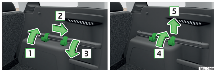
Fig. 103 Deslizar el gancho sobre el listón de fijación / retirar el gancho
