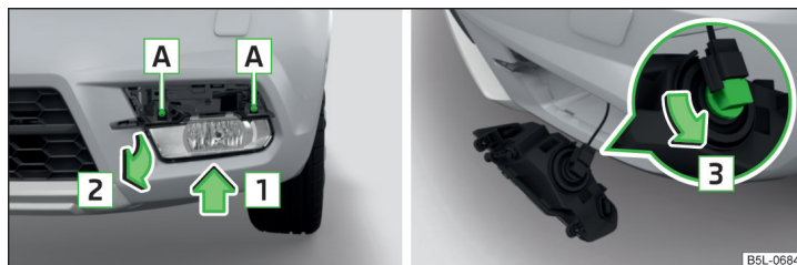
Fig. 202 Retirar el faro antiniebla / cambiar la bombilla
