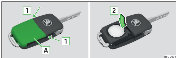
Fig. 182 Desmontar la tapa / extraer la pila
