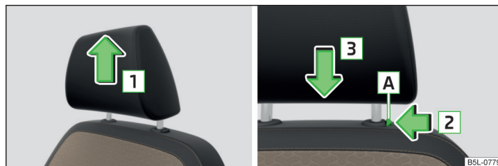
Fig. 67 Ajustar la altura del reposacabezas
