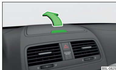
Fig. 71 Abrir el compartimento guardaobjetos
