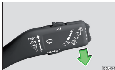
Fig. 189 Ajustar la posición de servicio de los brazos del parabrisa
