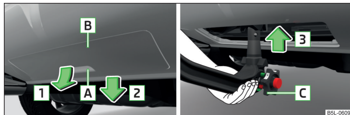
Fig. 146 Extraer la caperuza cobertera situada en el parachoques trasero / aplicar la barra de cabeza esférica
