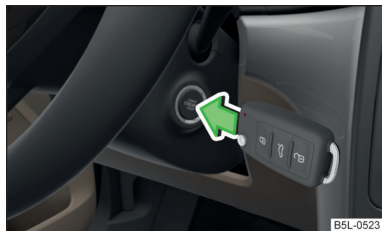
Fig. 122 Dejar el motor encendido - Presionar el botón con la llave
