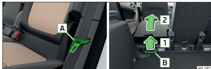
Fig. 62 Posición de seguridad del cinturón / abatir completamente el asiento
