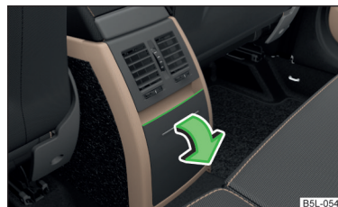
Fig. 92 Abrir el compartimento guardaobjetos
