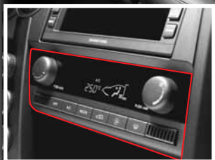
Panel de control del aire acondicionado / calefacción
