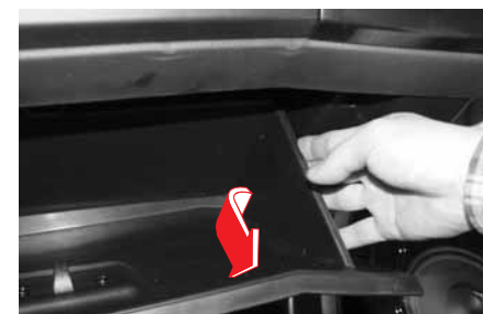
3. Baje el lado izquierdo de la guantera en la dirección indicada por la flecha.
