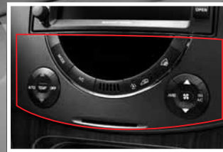
Panel de control del aire acondicionado / calefacción
