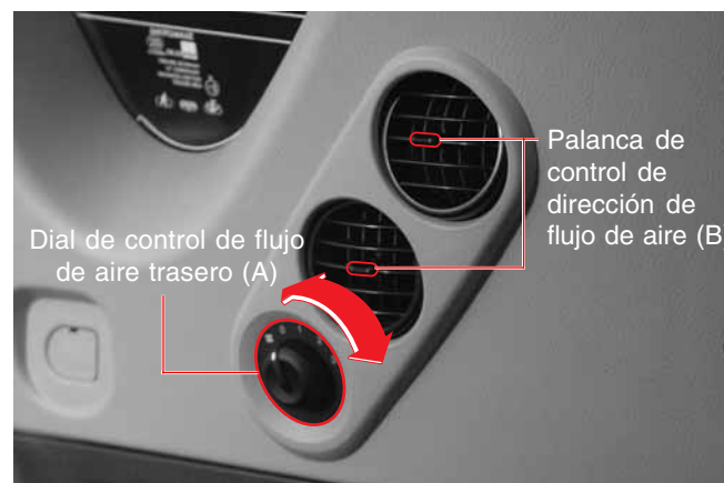
Dial de control de flujo de aire trasero (A)
