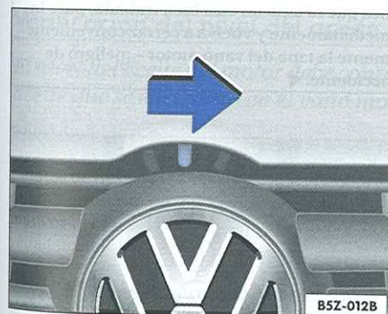
Fig. 111 Detalle de la rejilla del radiador: traba de seguridad para abrir el capó del vano motor
