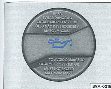
Fig. 114 En el vano motor: tapa del bocal de abastecimiento de aceite del motor
