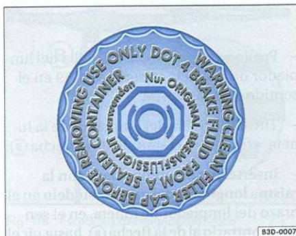
Fig. 120 En el compartimento del motor: tapa del recipiente del fluido de frenos
