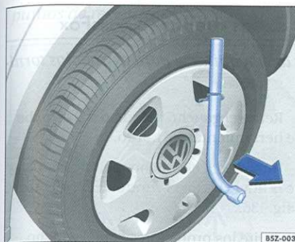
Fig. 133 Extraiga el embellecedor
