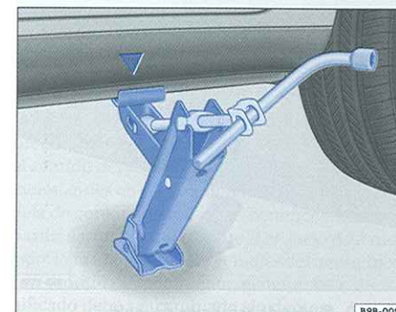
Fig. 139 Gato colocado en la parte trasera, lado izquierdo
