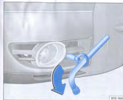
Fig. 160 Posición de la argolla de remolque delantera en el vehículo CrossFox
