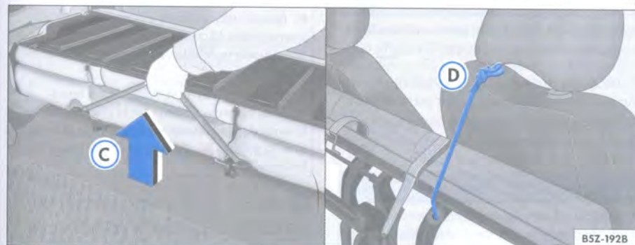
Fig. 81 Tirador para desbloquear el conjunto del piso / asiento inclinado fijado con la cinta elástica roja en la guía del apoyo para cabeza
