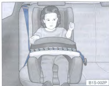
Fig. 22 Asiento infantil de la clase 1 montado en el sentido de la marcha en el asiento trasero
