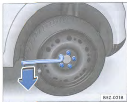
Fig. 138 Afloje los tornillos de la rueda
