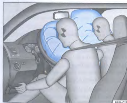
Fig. 20 Ilustración del funcionamiento: airbags insuflados
