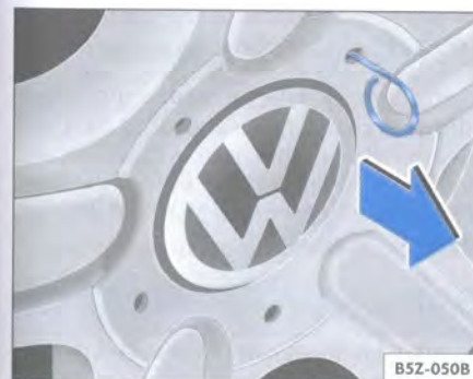
Fig. 135 Retire el tapacubo central con el gancho metálico - Lupo
