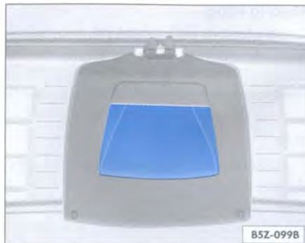
Fig. 44 Detalle del revestimiento interno de la tapa del maletero: rebajo para cerrar
