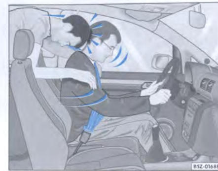
Fig. 8 El pasajero del asiento trasero que no se colocó el cinturón de seguridad, es proyectado hacia adelante, por encima de los pasajeros de los asientos delanteros
