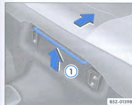
Fig. 75 Palanca para regulación longitudinal
