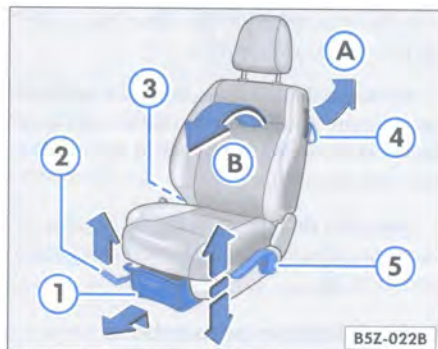
Fig. 67 Elementos para el ajuste del asiento delantero lado conductor
