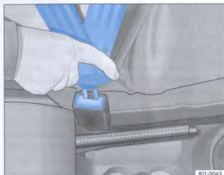
Fig. 10 Hebilla y lengüeta del cinturón de seguridad
