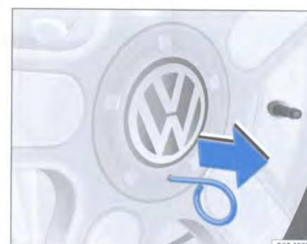
Fig. 136 Retire el tapacubos central con el gancho metálico - CrossFox
