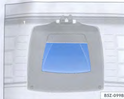
Fig. 40 Detalle del revestimiento interno la tapa del maletero: rebajo para cerrar
