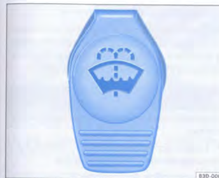
Fig. 118 En el compartimiento del motor: tapa del depósito del limpiaparabrisas / luneta trasera
