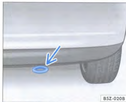
Fig. 161 Argolla de remolque trasera
