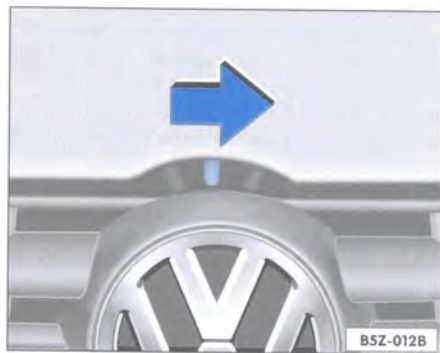
Fig. 112 Detalle de la rejilla del radiador: traba de seguridad para abrir el capó del compartimiento del motor
