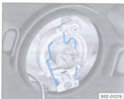
Fig. 147 Acceso a la lámpara del faro alto / bajo
