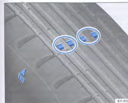
Fig. 123 Representación del perfil del neumático: indicadores de desgaste
