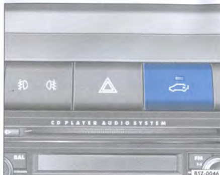
Fig. 42 Alerta para soporte de la rueda de repuesto desbloqueado
