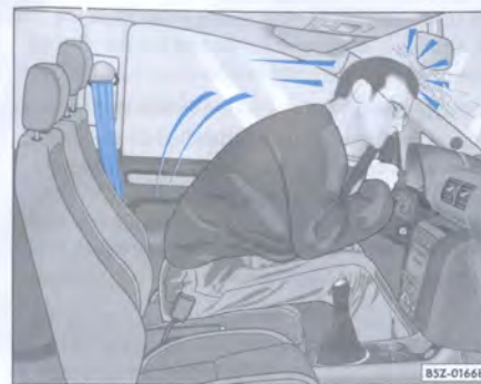
Fig. 7 El conductor que no se colocó el cinturón de seguridad es proyectado violentamente hacia adelante
