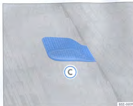
Fig. 77 Tirador interno para desbloqueo del respaldo
