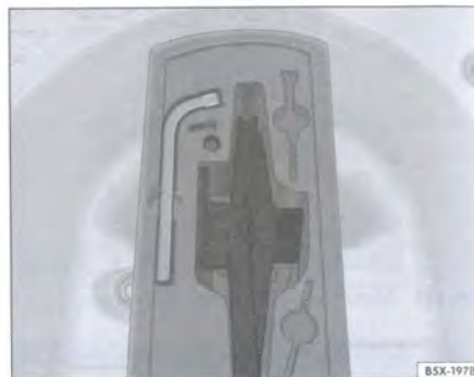
Fig. 127 Posicionamiento correcto del juego de herramientas con la parte curva orientada hacia adelante del vehículo - CrossFox
