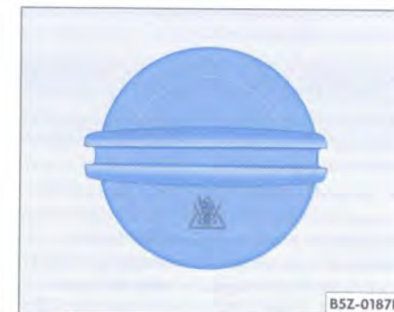
Fig. 117 En el compartimento del motor: remueva la tapa del depósito del líquido refrigerante
