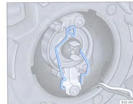
Fig. 152 Acceso a la lámpara del faro bajo
