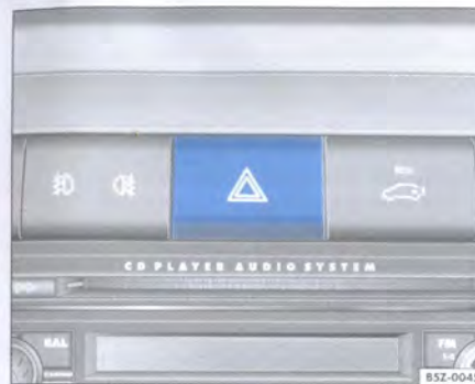
Fig. 51 Detalle en el cuadro: interruptor de la luz de advertencia
