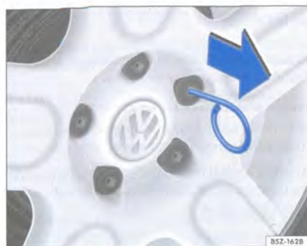
Fig. 137 Retire los protectores de los tornillos
