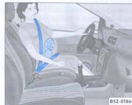
Fig. 16 Posición del cinturón de seguridad en mujeres embarazadas
