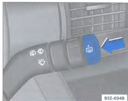
Fig. 52 Detalle en la palanca de los limpiadores: interruptor de la luneta trasera
