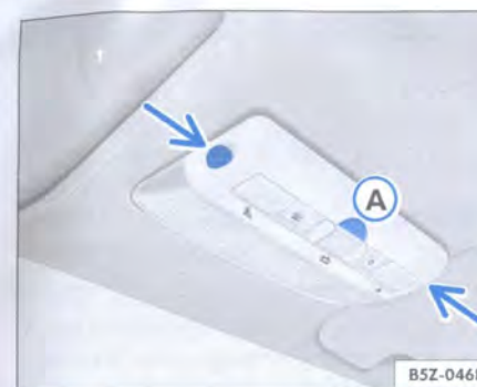
Fig. 38 Botón para desactivar la monitorización del compartimiento interno
