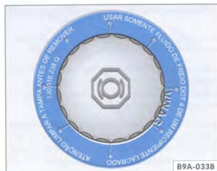
Fig. 121 Etiqueta circular encajada luego abajo de la tapa del depósito de fluido de los frenos
