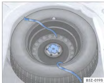
Fig. 131 Manija de fijación de la rueda de emergencia
