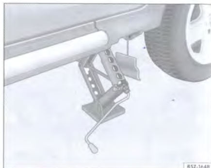
Fig. 142 Gato colocado en la parte trasera, lado izquierdo
