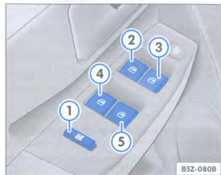
Fig. 46 Detalle del reposabrazos de la puerta del conductor: teclas de comando de los cristales e interruptor de seguridad de los vidrios traseros
