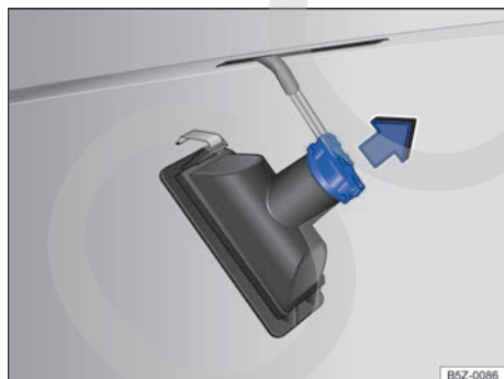
Fig. 178 Luz de la placa de licencia: desmonte el portalámpara de la lámpara.
