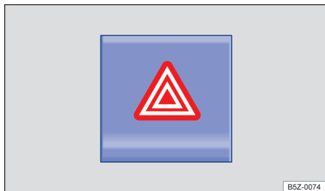
Fig. 144 En la parte superior de la consola central: interruptor de encender y apagar las luces de advertencia.
