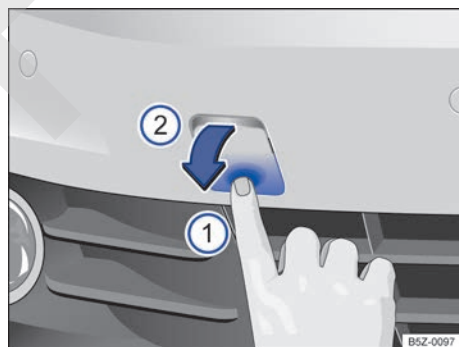
Fig. 181 En el parachoques delantero a la derecha: suelte y desmonte la cubierta. ►
