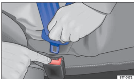
Fig. 47 Suelte la lengüeta del cinturón de seguridad del cierre del cinturón.
