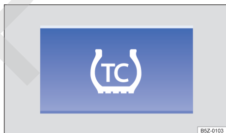
Fig. 108 En la consola central: tecla para desactivar y activar el TC (control de tracción) de forma manual.
