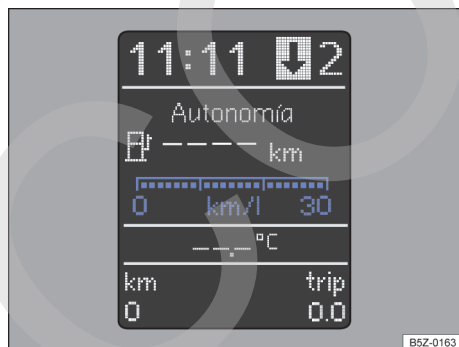
Fig. 11 En el panel de instrumentos: indicador del consumo de combustible.
