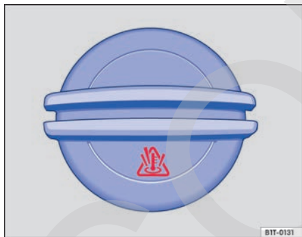
Fig. 131 En el compartimento del motor: tapón del depósito de expansión del líquido refrigerante de motor.
