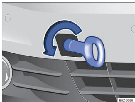
Fig. 182 En el parachoques delantero a la derecha: enrosque la argolla para remolque.
