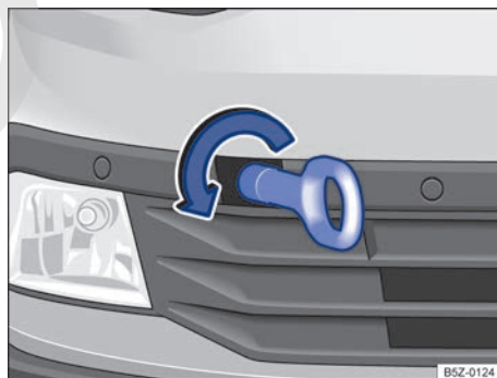
Fig. 184 En el parachoques delantero a la derecha: enrosque la argolla de remolque.
