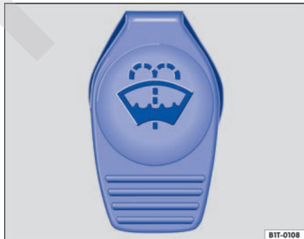
Fig. 66 En el compartimento del motor: tapa del depósito de agua de los lavavidrios.
