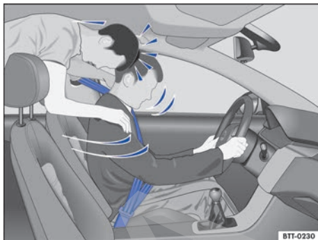
Fig. 44 El acompañante sin cinturón de seguridad en el asiento trasero es lanzado hacia adelante sobre el conductor con cinturón de seguridad.
