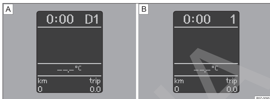
Fig. 100 (A) Posiciones de la palanca selectora en el display: indicación de la palanca en modo de conducción automatizada (Modo normal), en 1ª marcha. (B) Posiciones de la palanca selectora en el display: modo de conducción manual, con 1ª marcha seleccionada.
