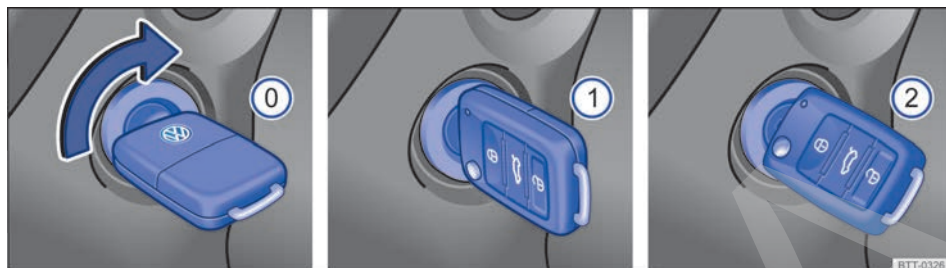
Fig. 92 Al lado del volante, a la derecha: posiciones de la llave del vehículo en la cerradura de encendido.
