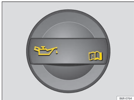
Fig. 128 En el compartimento del motor: tapón de la boca de llenado del aceite del motor.
