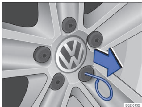
Fig. 158 Retire los capuchones de los tornillos de rueda.
