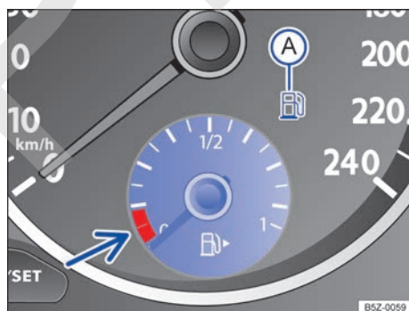
Fig. 123 En el panel de instrumentos: indicador del nivel de combustible.
