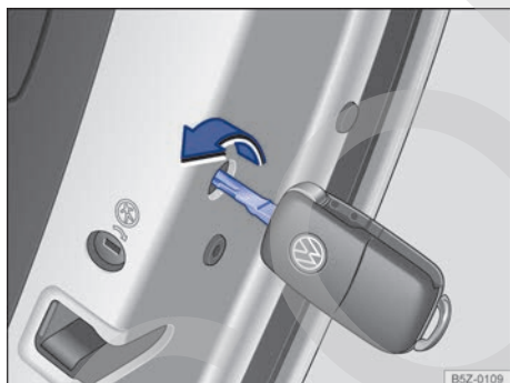
Fig. 151 Cierre de emergencia del vehículo con la llave del vehículo.
