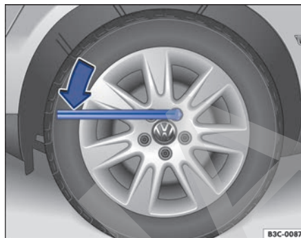
Fig. 160 Cambio de rueda: afloje los tornillos de la rueda.
