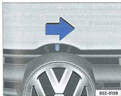
Fig. 111 Detalle de rejilla del radiador: traba de seguridad para abrir el capó del vano motor
