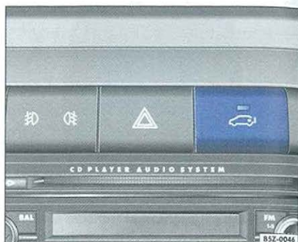
Fig. 42 Alerta para soporte de la rueda de repuesto desbloqueado
