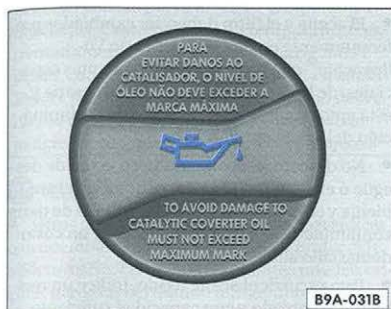
Fig. 114 En el vano motor: tapa del bocal de abastecimiento de aceite del motor
