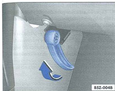
Fig. 110 Detalle de la zona reposapiés en el lado del conductor: Palanca de desbloqueo de la tapa del vano motor
