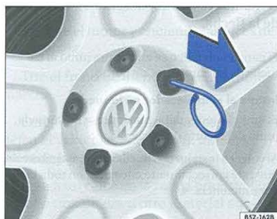
Fig. 136 Retire los protectores de los tornillos
