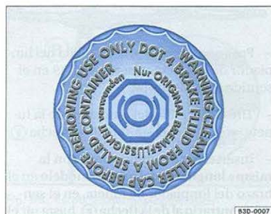
Fig. 120 En el compartimiento del motor: tapa del recipiente del fluido de frenos
