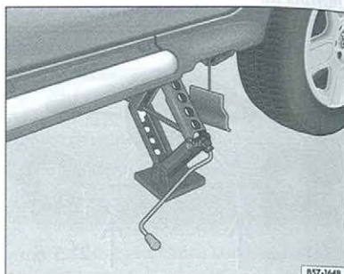
Fig. 141 Gato colocado en la parte trasera, lado izquierdo
