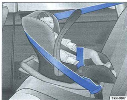
Fig. 21 Asiento infantil de la clase 0 montado en el sentido contrario al de la marcha en el asiento trasero
