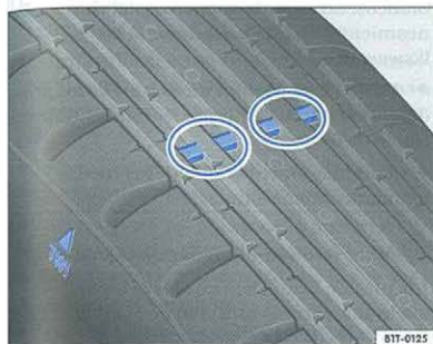
Fig. 122 Representación del perfil del neumático: indicadores de desgaste
