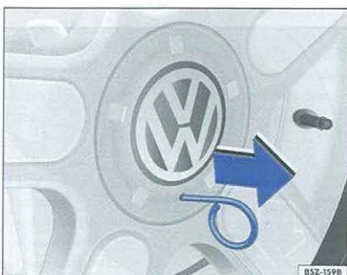
Fig. 135 Retire el tapacubos central con el gancho metálico - CrossFox
