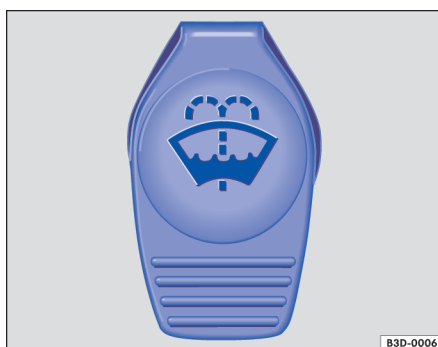
Fig. 102 En el vano motor: tapa del depósito del limpiaparabrisas/luneta trasera
