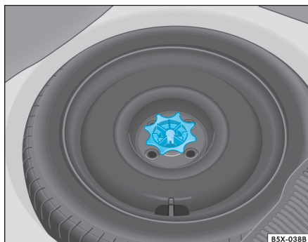
Fig. 111 Rueda de repuesto ubicada debajo de la cubierta del maletero
