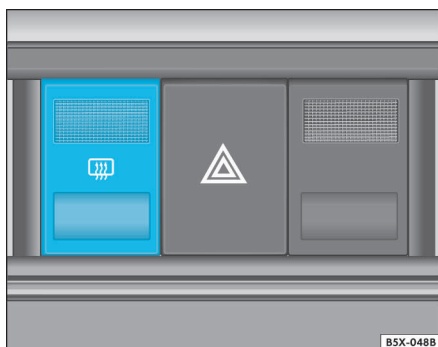
Fig. 44 Detalle en el cuadro de instrumentos: interruptor del luneta térmica del cristal trasero
