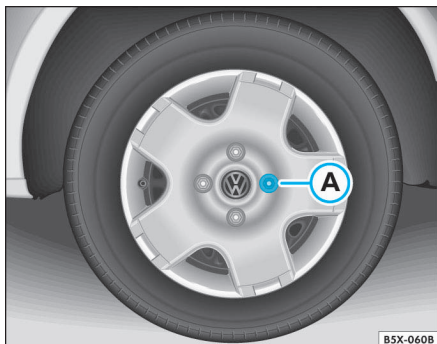
Fig. 119 Secuencia de retirada de los tornillos de la rueda
