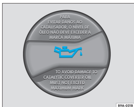
Fig. 99 En el vano motor: Tapa del bocal de abastecimiento de aceite del motor
