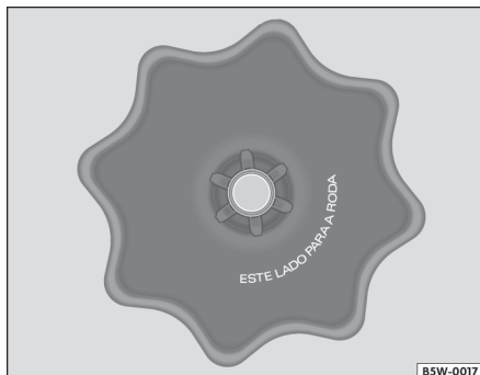
Fig. 120 Detalle del montaje correcto del fijador de la rueda de repuesto
