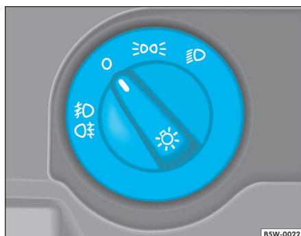
Fig. 41 Detalle en el cuadro de instrumentos: interruptor de las luces
