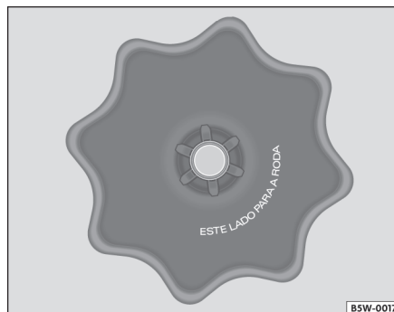
Fig. 114 Detalle del montaje correcto del fijador de la rueda de repuesto
