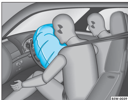
Fig. 19 Ilustración del funcionamiento: airbag frontal insuflado
