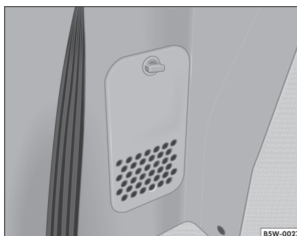
Fig. 74 Cubierta ventilada en el habitáculo
